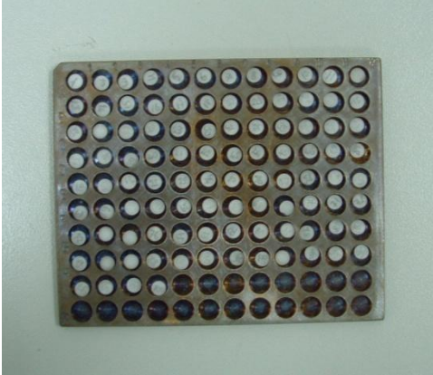
Resim 3.5. Çalışmamızda kullanılan Lityum Florür (LiF) TLD çipleri
