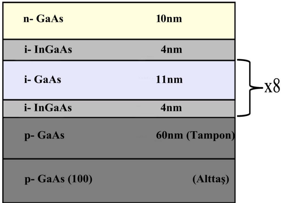
Şekil 4.3. GS174 QWSC yapısı
