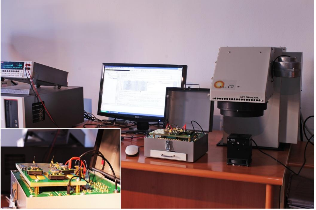
Resim 4.10. I-V ölçüm düzeneği (Keithley 4200 ve NewPort Oriel Sol1A)
