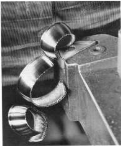
Şekil 2.20. Dalgalı biçime sahip kesici takımla talaş kaldırma [3]
