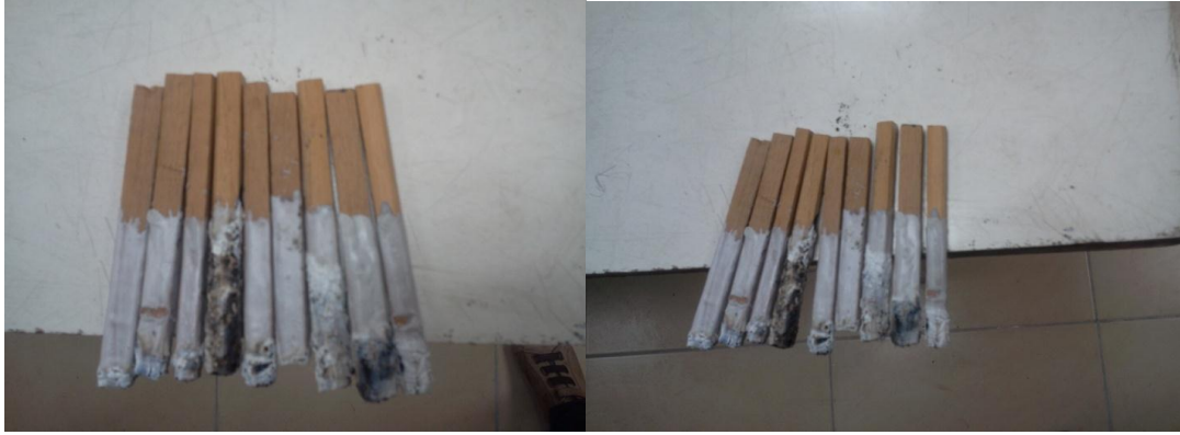
Resim 4.11. %39 oksijen konsantrasyonu ile yakılan numuneler
