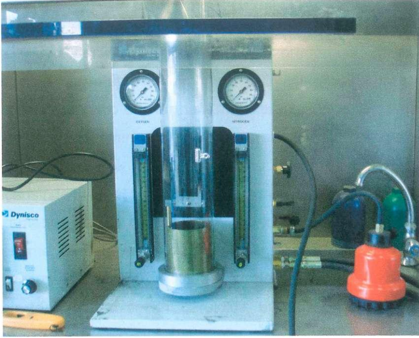
Resim 3.5. LOI test cihazı
