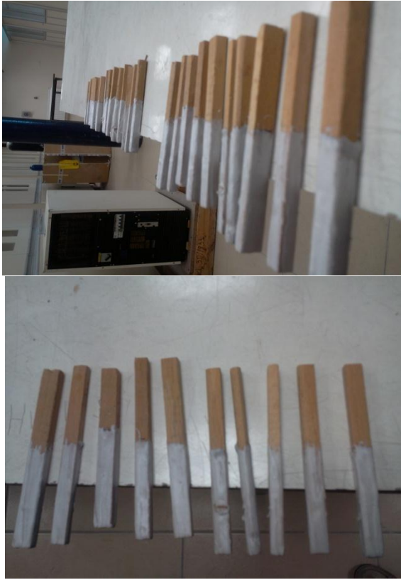
Resim 3.6. Silikon esaslı bağlayıcı ile hazırlanan ahşap numune
