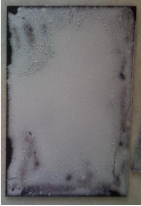
Resim 4.9. 700 °C'de magnezyum borat pigmentli boya ile kaplanmış levha
