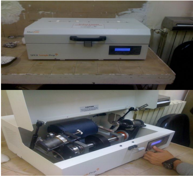
Resim 3.1. SPEKS SAMPLE PREP marka değirmen cihazı
