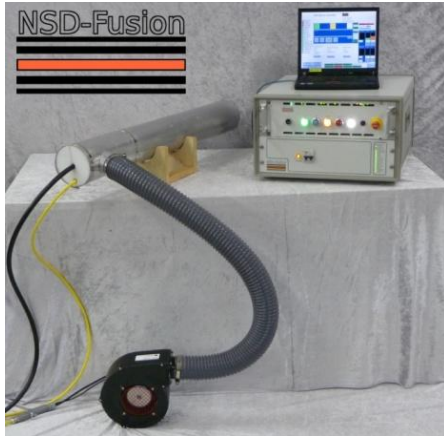
Resim 2.2. Ticari IEC nötron üretici [www.nsd-fusion.com]
