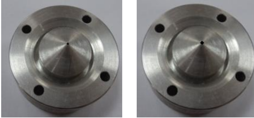
Resim 4.3. İyon kaynağı bağlantı elemanının a) ~1 mm, b) ~2 mm çap açıklığı
