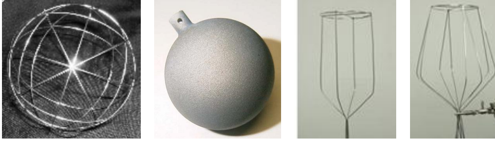
Resim 2.3. Farklı geometriye sahip katotlar
