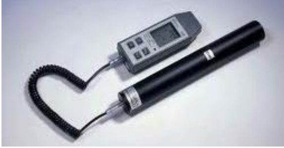
Resim 3.12. Thermo FH 40 G ünitesi ve FHT 752 SH problu nötron dedektörü
