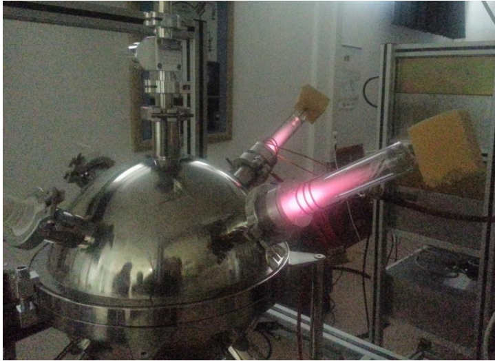
Resim 4.4. SANAEM-IEC cihazında iki iyon kaynağı ile elde edilen plazmanın görüntüsü
