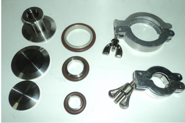
Resim 3.6. Bazı vakum elemanları
