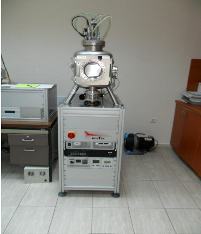
Resim 3.3. Omik ve doğrultucu kontak oluşturulmasında kullanılan vakumda buharlaştırma sistemi.
