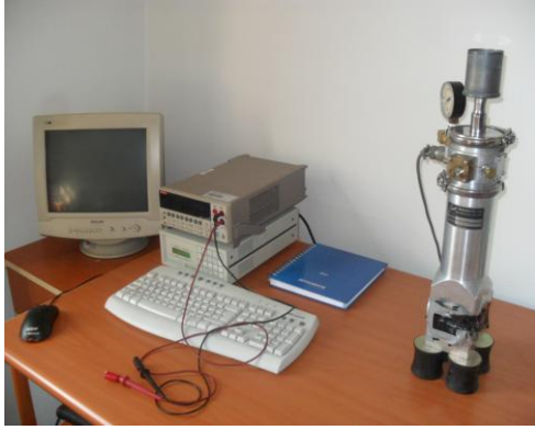
Resim 3.5. Akım-gerilim ölçümleri için kullanılan deneysel ölçüm düzeniği.
