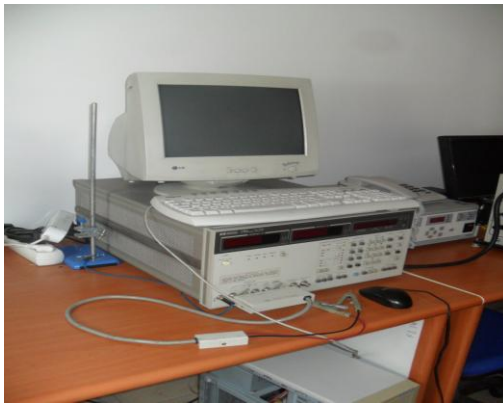
Resim 3.6. Kapasitans-voltaj ve iletkenlik-voltaj ölçümleri için kullanılan deneysel ölçüm düzeniği .
