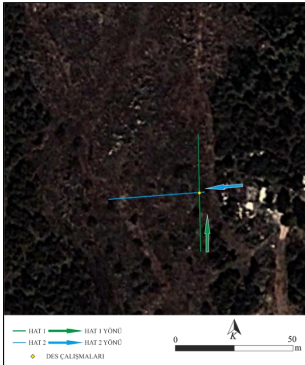
Şekil 4.64. Kampüs alanı 5 numaralı çalışma bölgesinde gerçekleştirilen çok elektrotlu elektrik özdirenç çalışma hatları ve düşey elektrik sondajı çalışma noktaları
