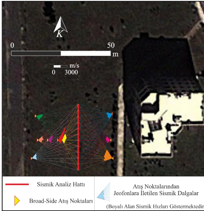
Şekil 4.18. Kampüs alanı 1 numaralı çalışma bölgesinde gerçekleştirilen Broad-Side analizinden elde edilen sismik hızların ve sismik dalgaların harita üzerinde gösterilmesi
