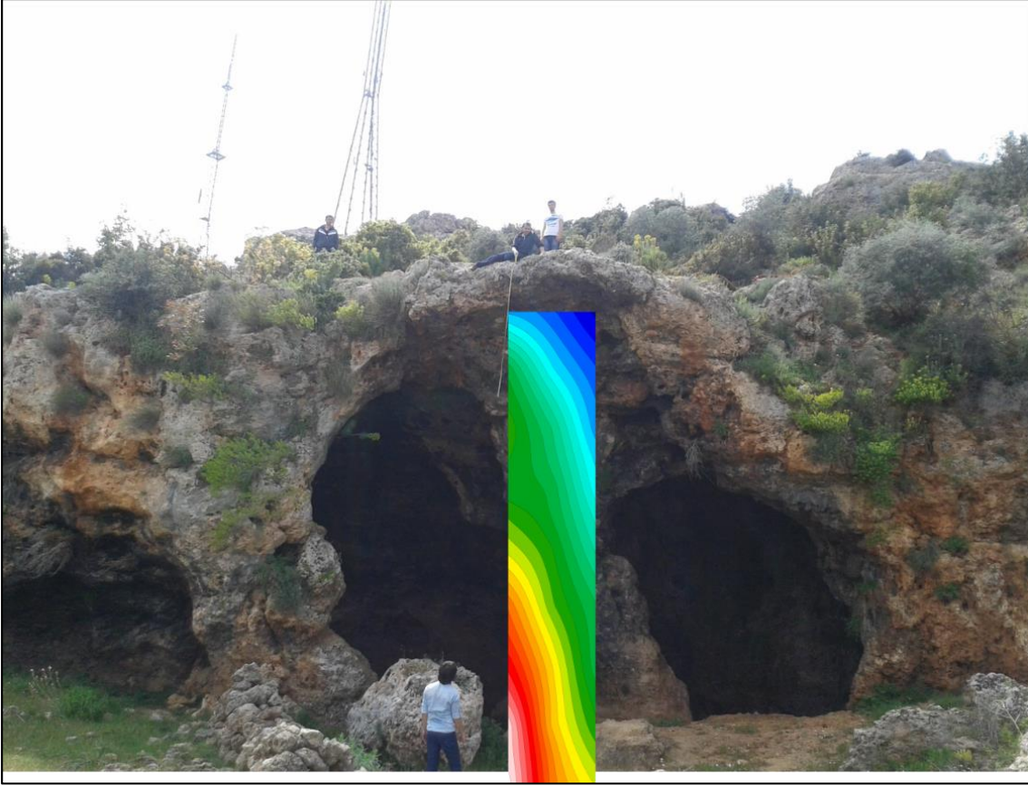
Şekil 4.83. Masa Dağı alanı 1 numaralı çalışma bölgesinde yapılan DES ölçümü ve sonuçların topoğrafik kesit üzerinde görünümü
