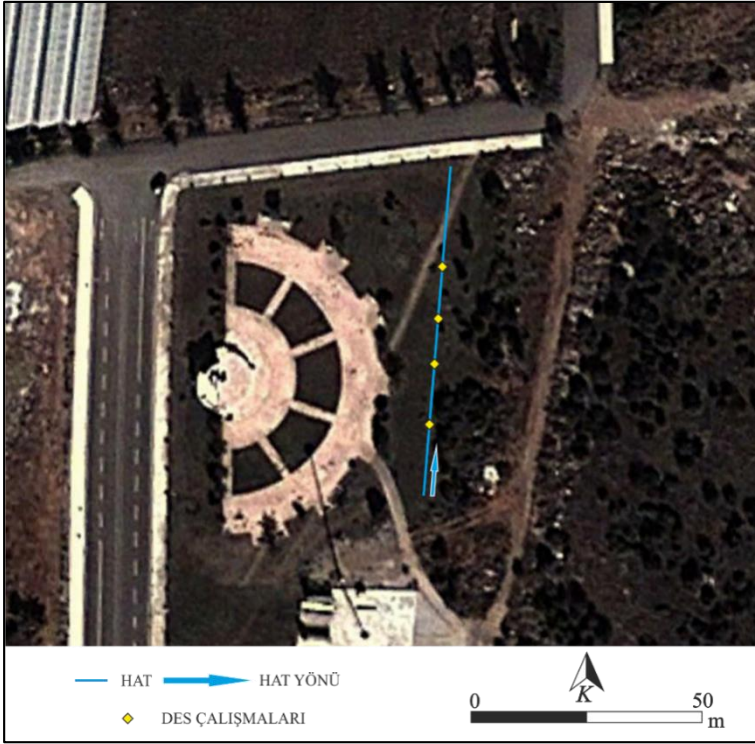
Şekil 4.36. Kampüs alanı 2 numaralı çalışma bölgesinde gerçekleştirilen çok elektrotlu elektrik özdirenç çalışma hatları ve düşey elektrik sondajı çalışma noktaları
