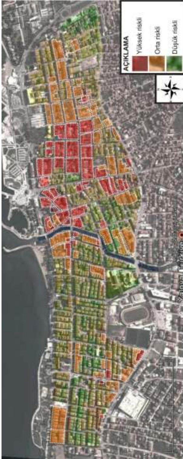
Harita 4.22. TOPSIS analizi ile elde edilen zemin kriterleri ile alt yapı ve üst yapı kriterlerinin dikkate alındığı göreceli risk haritasının Google Earth görüntüsüyle birleştirilmiş hali
