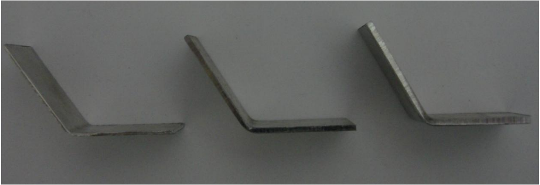
Resim 6.5. 1-1,5 ve 2 mm kalınlığındaki AL 5754 sac malzemelerin, 120° açılı ve 1 mm uç kavisli zımba ile bükülmesi sonu elde edilen numuneler
