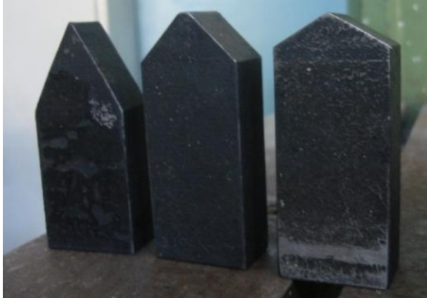
Resim 5.2. Deneysel çalışmalarda kullanılan bükme zımbaları
