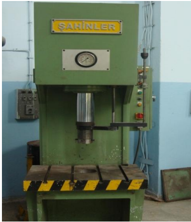
Resim 5.6. Bükme işleminde kullanılan pres tezgahı
