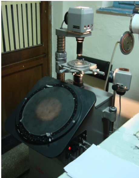
Resim 5.7. Ölçme işleminde kullanılan profilometre
