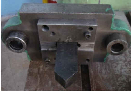
Resim 5.4. Kalıp üst ve alt grup montajı
