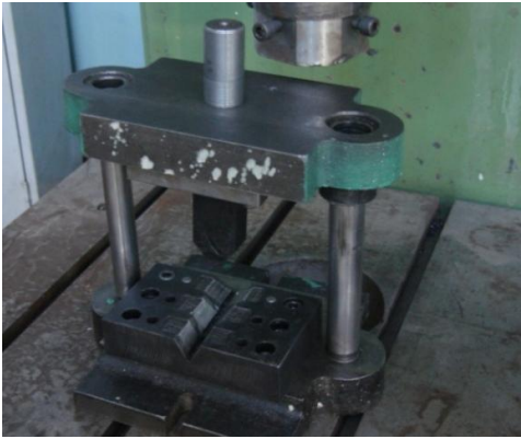
Resim 5.5. Kalıp komple montajı
