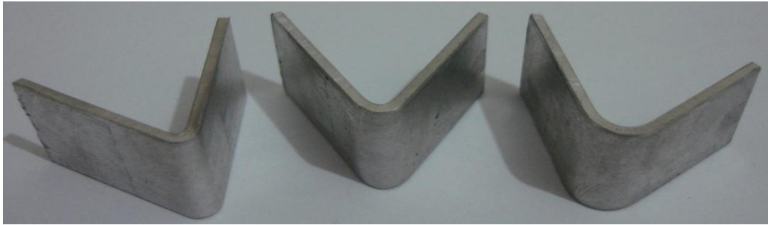
Resim 6.3. 2 mm kalınlığındaki AL 5754 sac malzemelerin, 60° açılı ve 1, 2 ve 4mm uç kavisli zımba ile bükülmesi sonucu elde edilen numuneler
