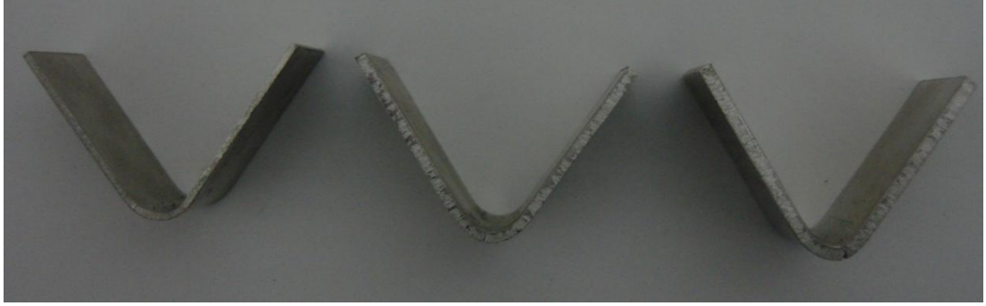
Resim 6.6. 1-1,5 ve 2 mm kalınlığındaki AA 2024 sac malzemelerin, 60° açılı ve 4 mm uç kavisli zımba ile bükülmesi sonu elde edilen numuneler
