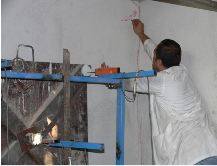
Resim 5.5. -200 kN' luk uygulanan çekme kuvveti ile iç yüzeyde oluşan çatlaklar
