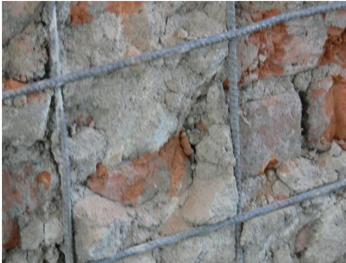
Resim 5.10. D 2 deney örneğinin deneyden sonra hasır çeliğin görüntüsü
