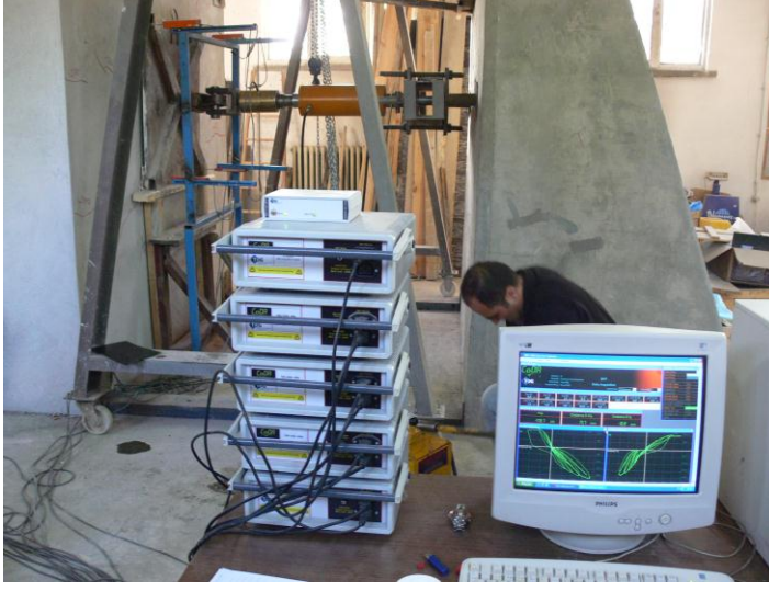
Resim 4.17. Deneyde kullanılan veri aktarım sistemi ve bağlantısı
