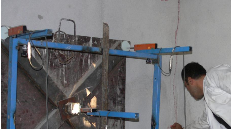
Resim 5.1. D 2 deney örneğinde sol iç duvar kesişiminde oluşan çatlak
