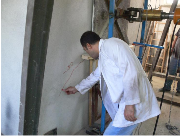
Resim 5.3. D_2 deney örneğinde, -180 \text{ kN} ' da yükleme profilinin sol alt köşesinde oluşan kesme çatlakları
