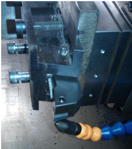
Resim 4.18. MMY sistemin kesici takım üzerine uygulanması
