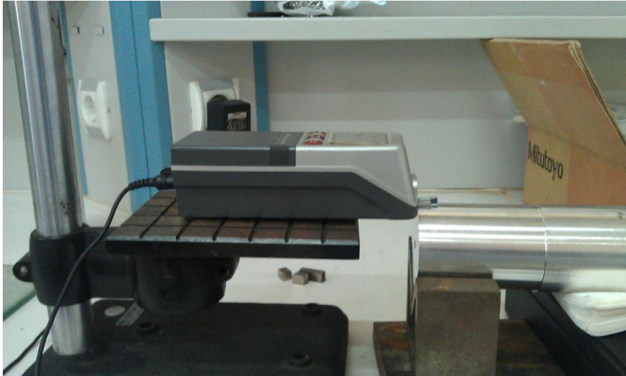
Resim 4.24. AZ91D işleme sonrası yüzey pürüzlülük ölçümü
