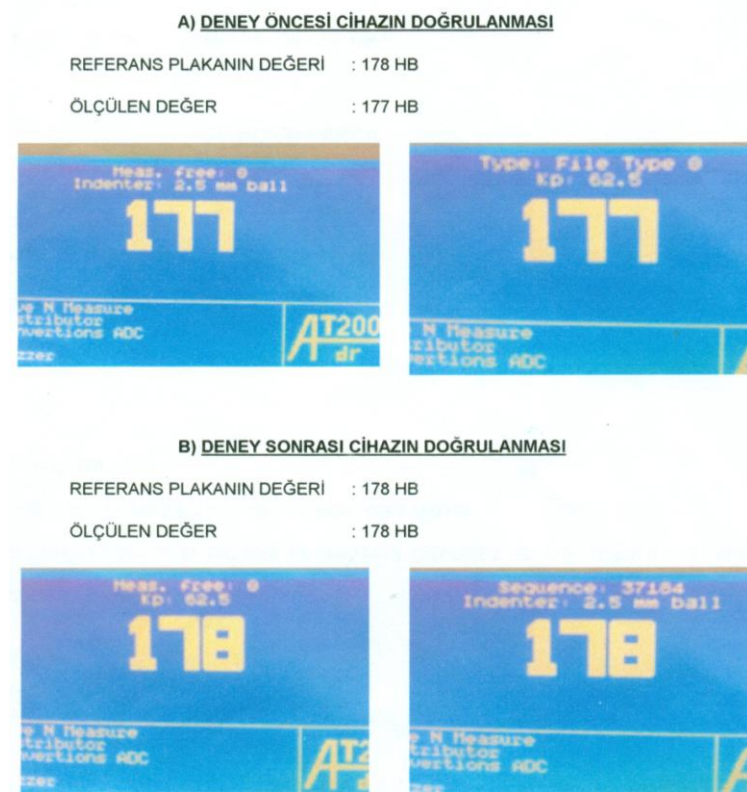
Resim 5.4. Sertlik ölçüm cihazının doğrulamasının gösterimi
