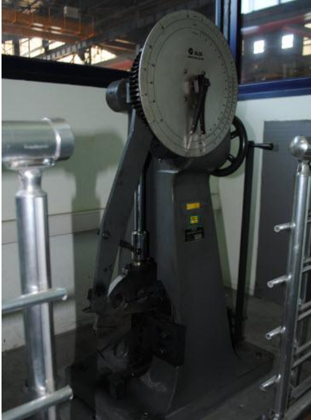
Resim 4.6. Alşa darbe test cihazı
