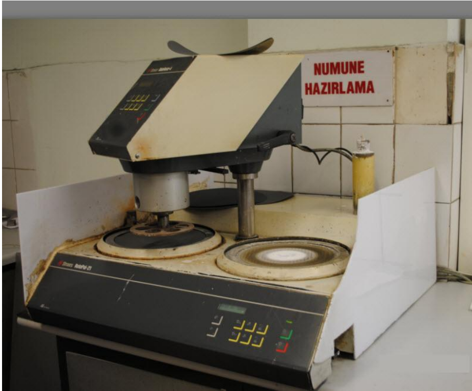
Resim 4.3. Struers Rotopol 21 parlatma cihazı
