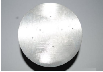
Resim 5.5. AZ91 kesilen yüzeyde sertlik ölçümü
