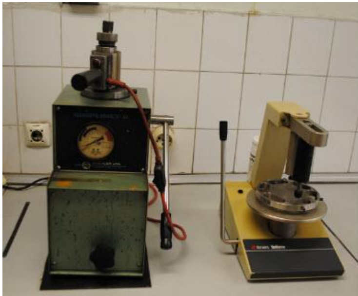
Resim 4.2. Buehler Simplimet II bakalite alma cihazı
