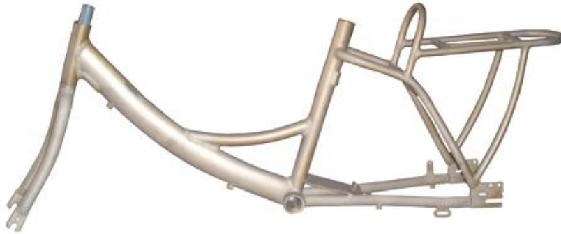
Resim 3.6. Magnezyum alaşımından üretilmiş bisiklet şasesi
