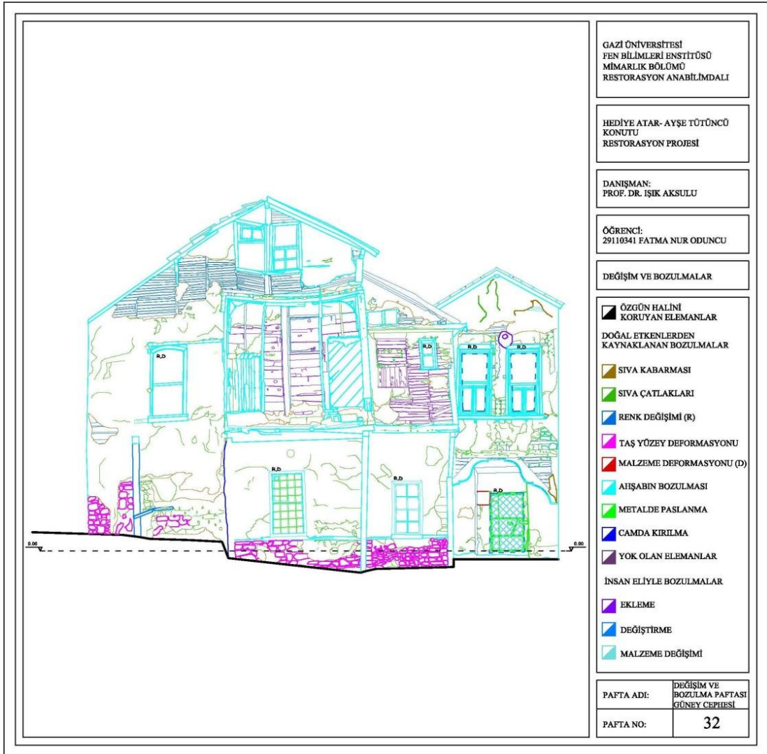
Şekil 3.34. Değişim ve bozulmalar güney cephesi
