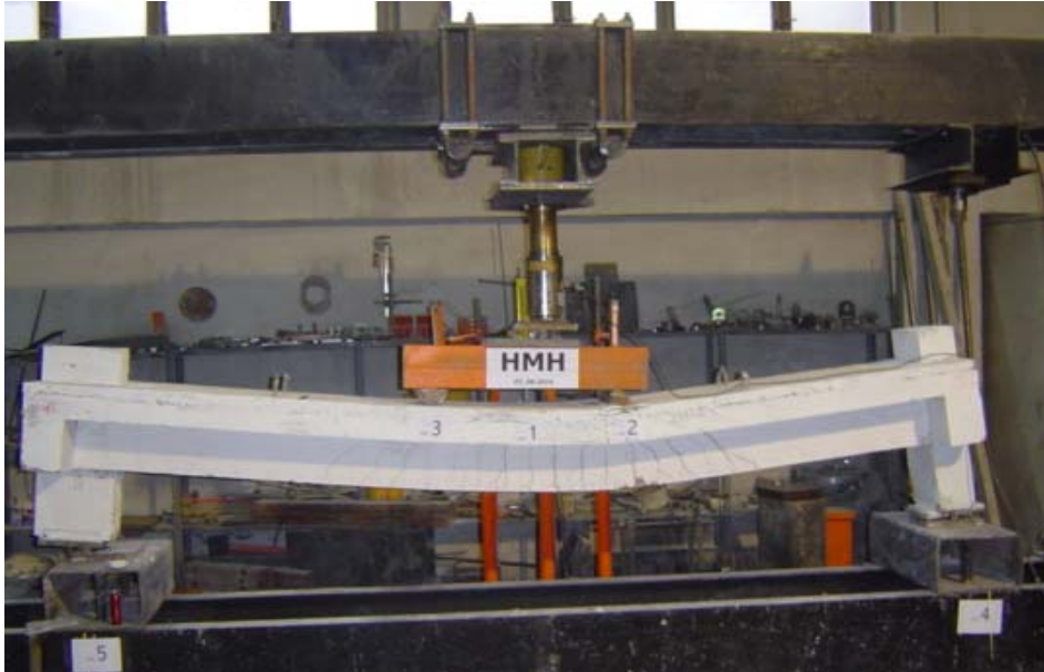
Resim 3.43. HMH deney elemanının deney sonrası hasar durumu
