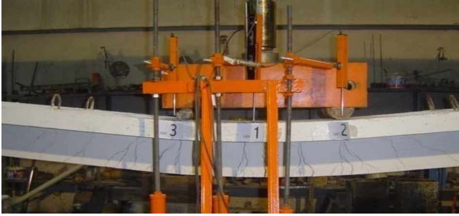
Resim 3.26. MRH elemanında meydana gelen eğilme çatlakları
