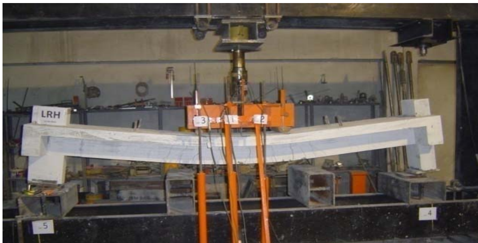
Resim 3.11. LRH deney elemanının deney sonrası hasar durumu
