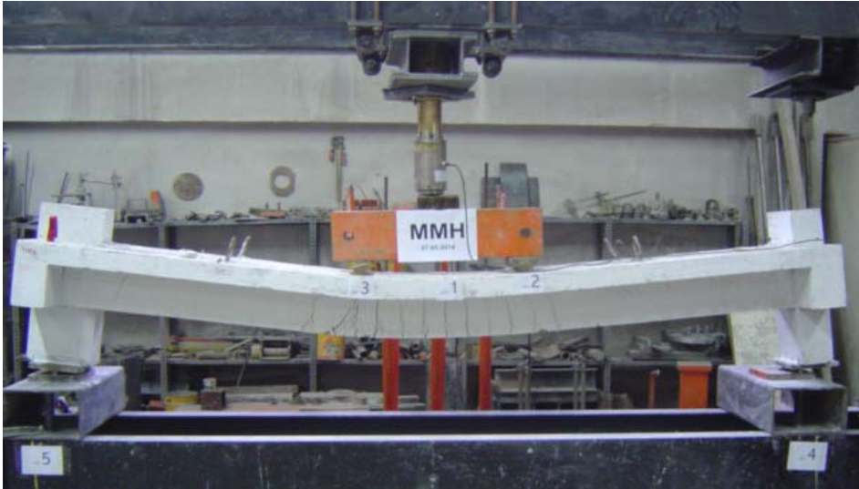
Resim 3.28. MMH deney elemanının deney sonrası hasar durumu
