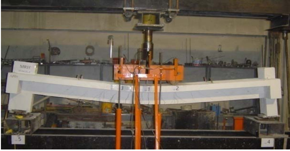
Resim 3.25. MRH deney elemanının deney sonrası hasar durumu
