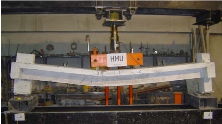
Resim 3.46. HMU deney elemanının deney sonrası hasar durumu
