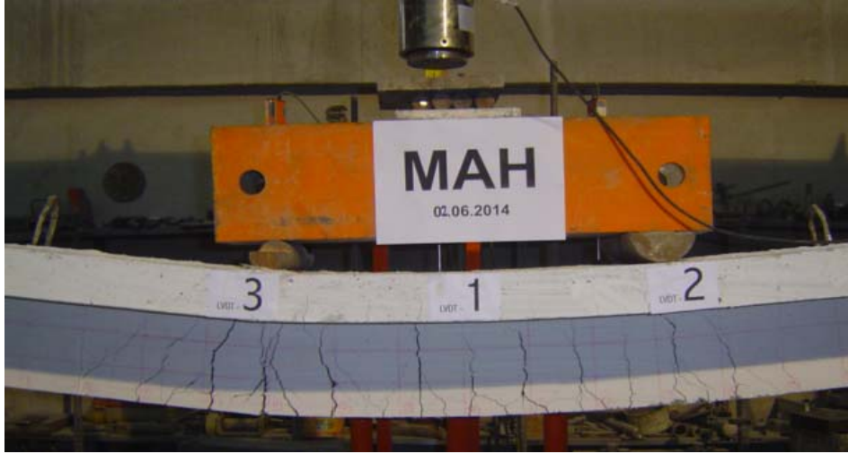
Resim 3.35. MAH elemanında meydana gelen eğilme çatlakları
