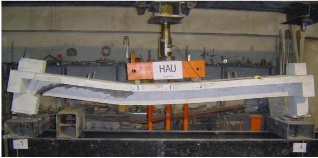
Resim 3.53. HAU deney elemanının deney sonrası hasar durumu
