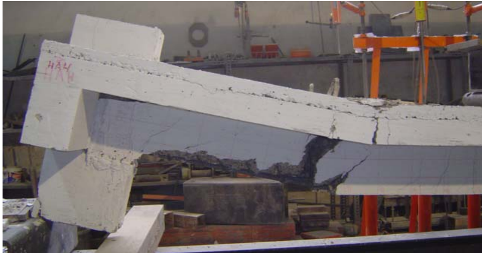
Resim 3.51. HAH elemanında meydana gelen kesme çatlakları
