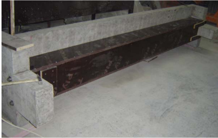
Resim 3.8. Sonradan oluşturulmuş kirişin kalıbı
