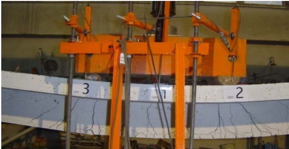
Resim 3.38. MAU elemanında meydana gelen eğilme çatlakları
