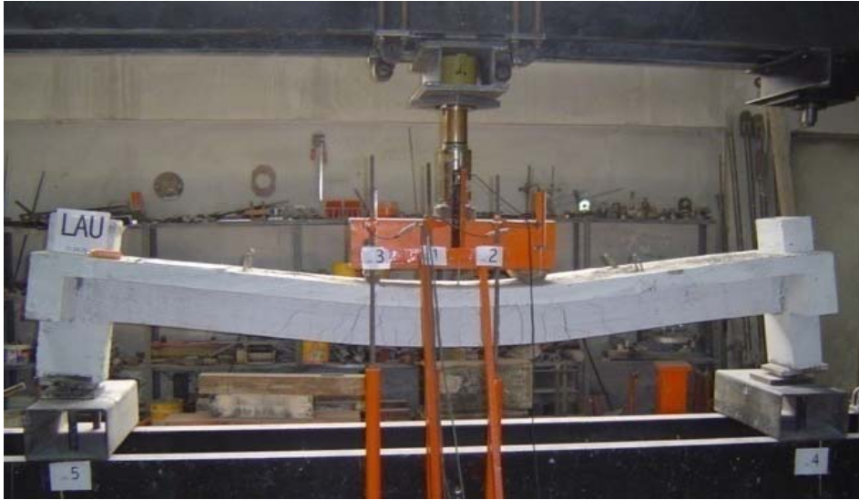
Resim 3.22. LAU deney elemanının deney sonrası hasar durumu
