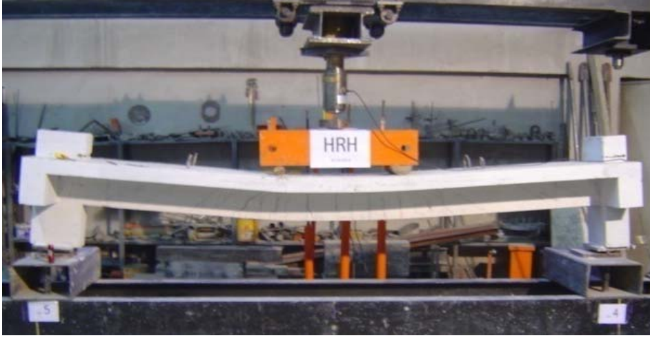
Resim 3.40. HRH deney elemanının deney sonrası hasar durumu
