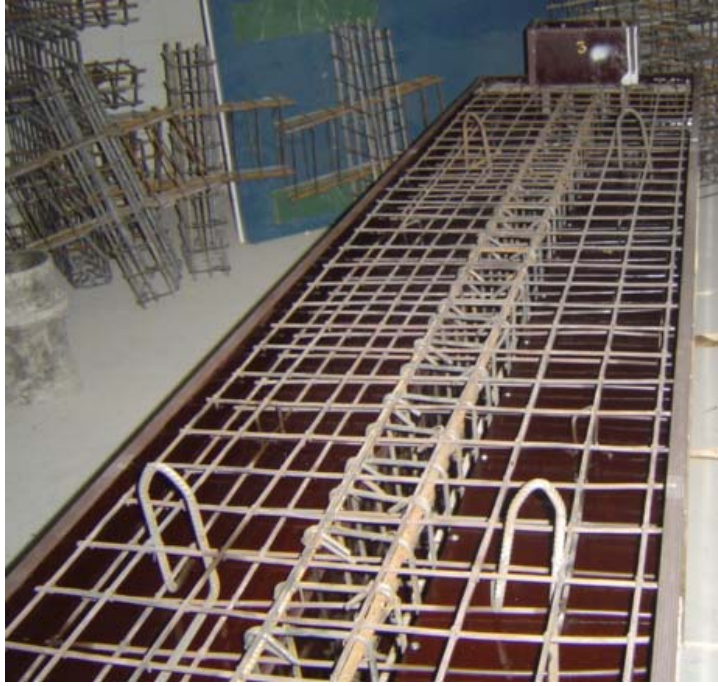
Resim 3.3. Birdöküm eleman kalıbı ve donatıları
