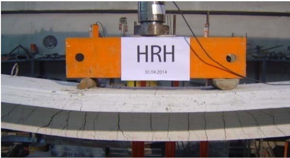
Resim 3.41. HRH elemanında meydana gelen eğilme çatlakları
