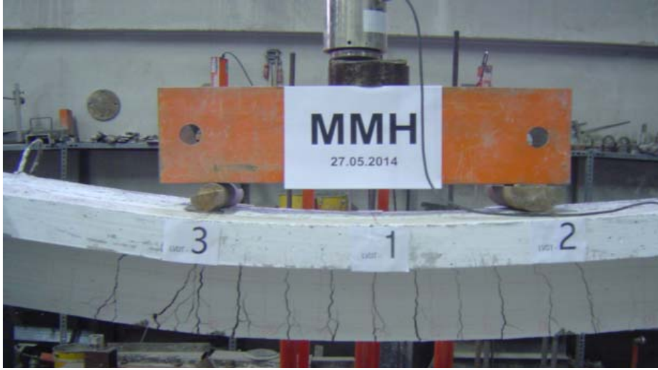
Resim 3.29. MMH elemanında meydana gelen eğilme çatlakları
