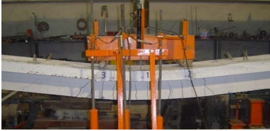
Resim 3.32. MMU elemanında meydana gelen eğilme çatlakları
