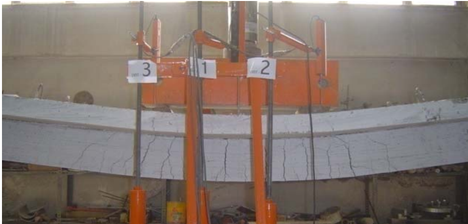
Resim 3.23. LAU elemanında meydana gelen eğilme çatlakları
