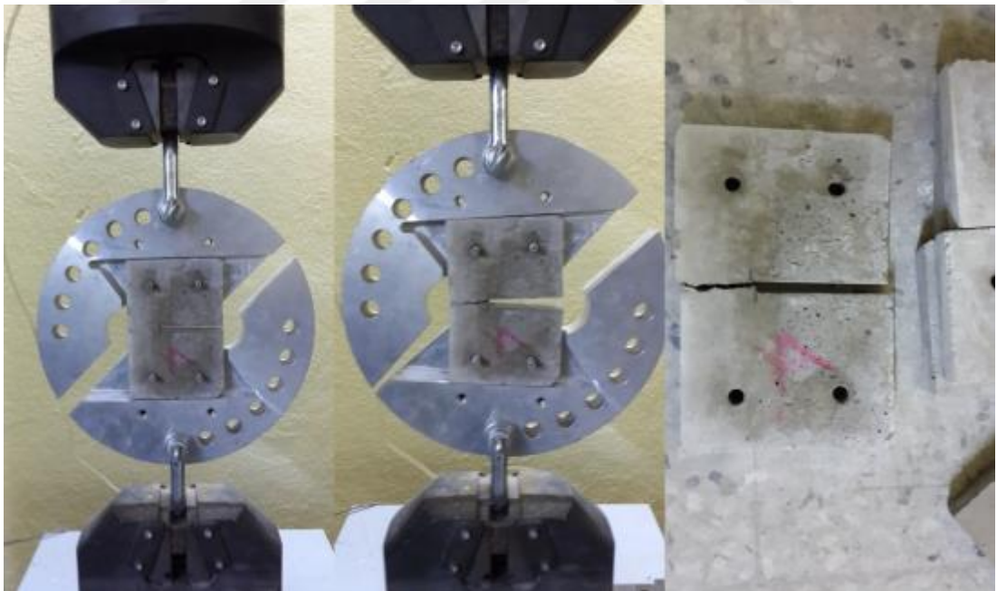
Resim 7.3. 0° olan 66 Günlük %64 çentikli numunede kırılma hattı
