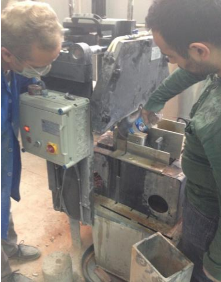
Resim 4.8. Çentik açılması işlemi
