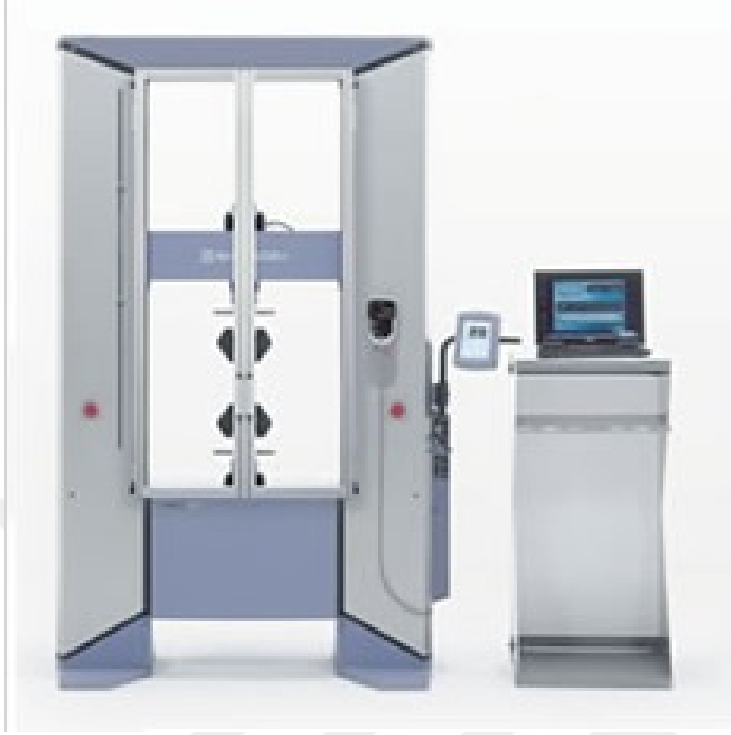
Resim 5.2. Arcan deneyinin yapıldığı çekme çerçevesi
