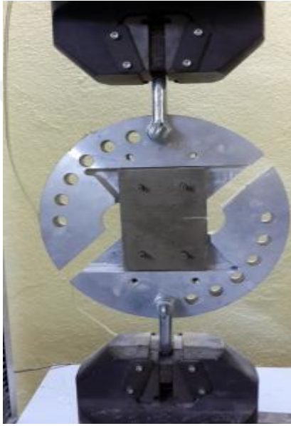
Resim 4.9. Arcan deney düzeneğine numunelerin yerleştirilmesi
