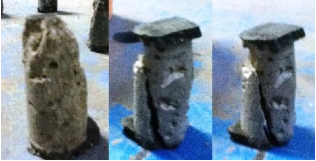
Resim 7.21. Nanosuz küçük boy basınç silindirlerinde kırılma hatları
