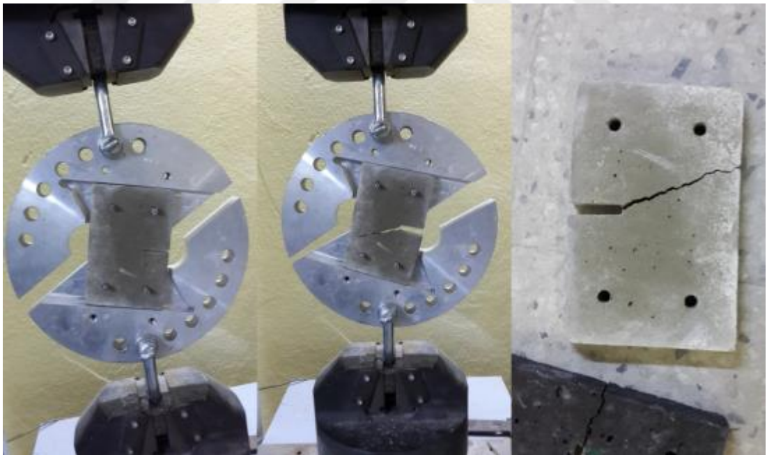
Resim 7.5. 15 0 olan 61 Günlük %32 çentikli numunede kırılma hattı
