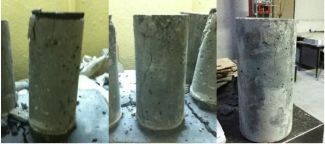
Resim 7.22. Nanolu büyük boy basınç silindirlerinde kırılma hatları
