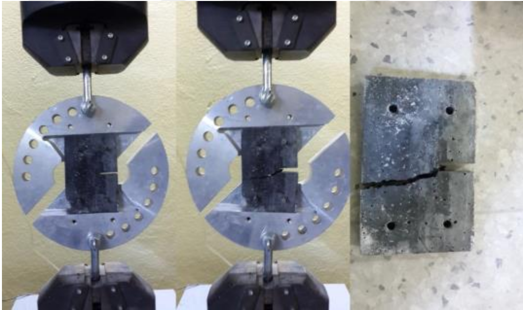
Resim 7.11. 0° olan 66 Günlük %32 çentikli numunede kırılma hattı
