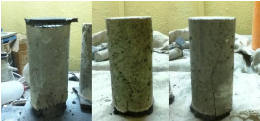
Resim 7.19. Nanosuz büyük boy basınç silindirlerinde kırılma hatları
