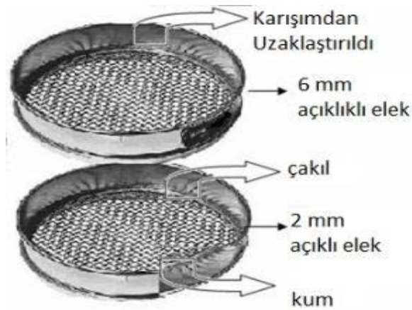
Şekil 4.3. Elek analizinin şematik olarak gösterimi
