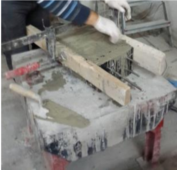
Resim 4.5. Sarsma tablası yardımıyla vibrasyon (sıkıştırma) işlemi
