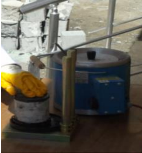
Resim 4.14. Temsili silindir başlık yapımı örneği
