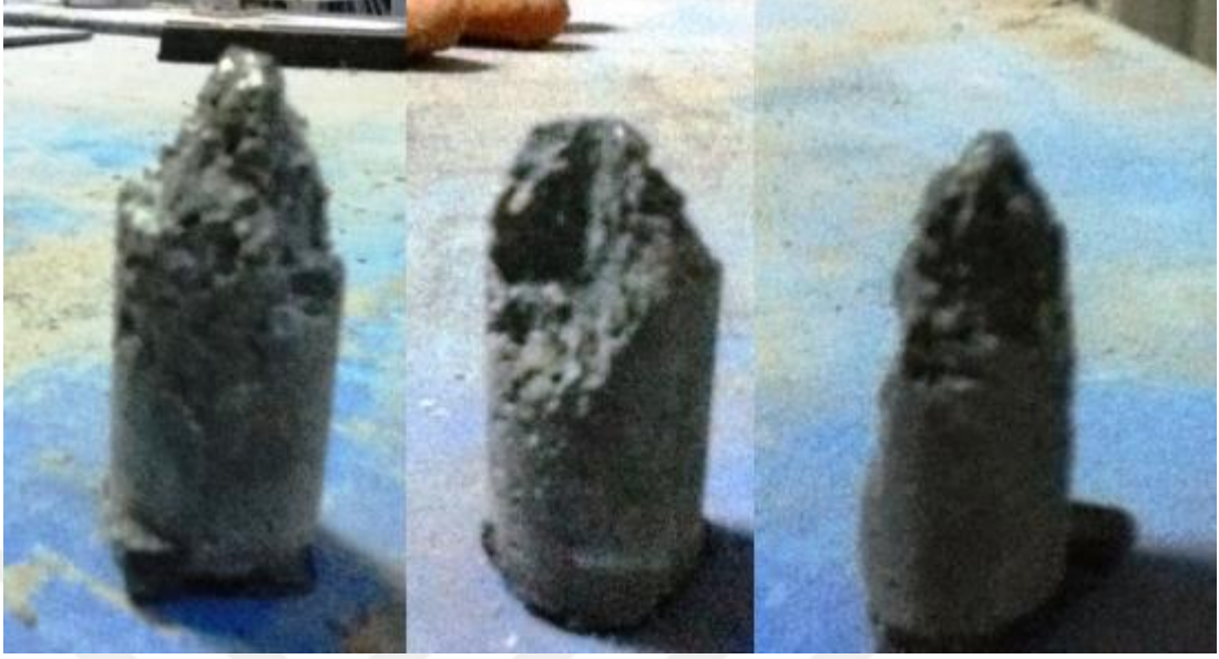
Resim 7.24. Nanolu küçük boy basınç silindirlerinde kırılma hatları
