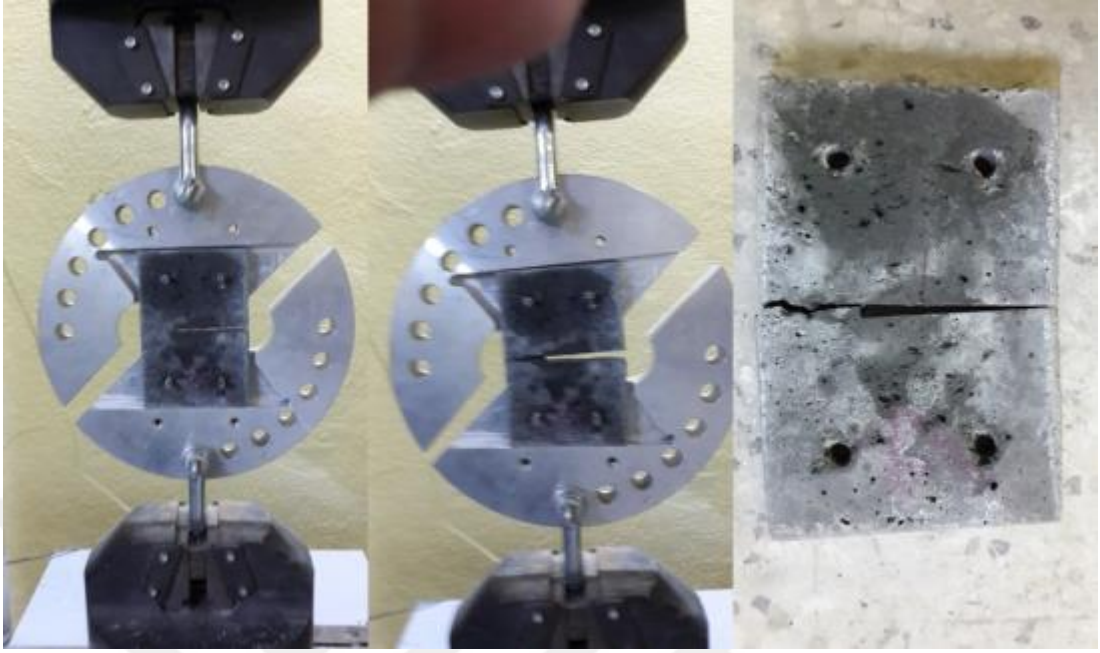
Resim 7.12. 0^{\circ} olan 66 Günlük %64 çentikli numunede kırılma hattı
