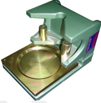
Resim 4.13. Silindir başlık yapımı için kullanılan alet
