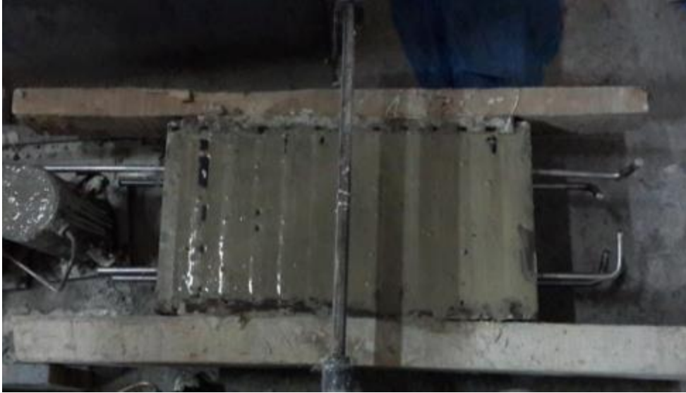
Resim 4.3. Çekmeye maruz nano malzeme içermeyen prizmalar için kullanılan ahşap kalıp
