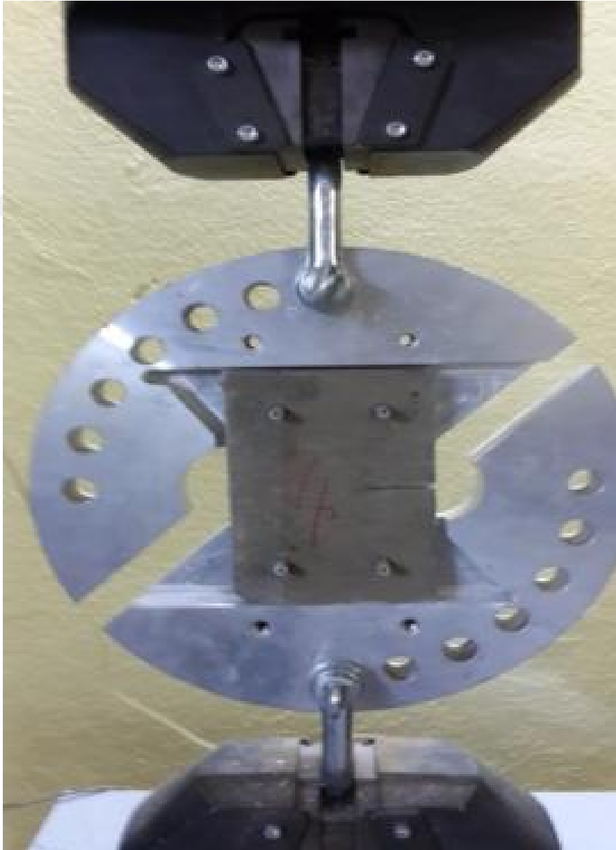
Resim 5.3. Kullanılan arcan deney aparatı ( \alpha=0^\circ )
