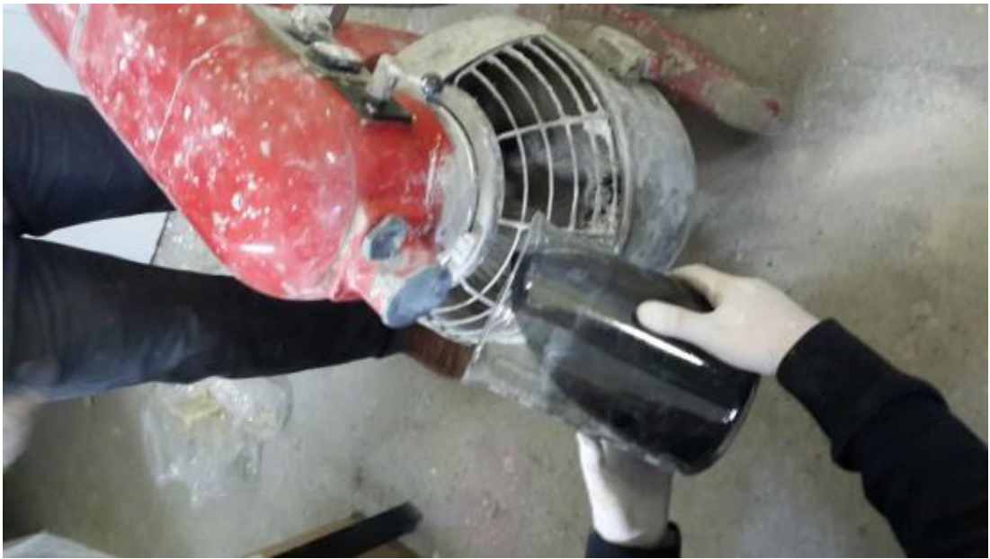
Resim 4.2. Beton karıştırıcısı ile karışımın hazırlanması
