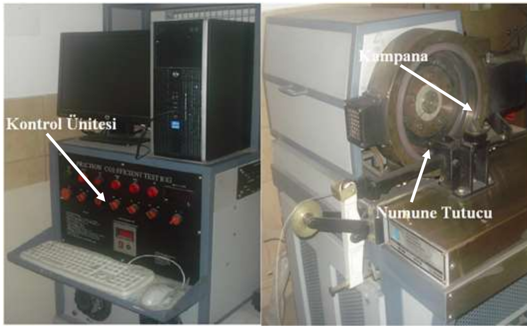
Resim 5.10. Chase tipi sürtünme aşınma test cihazı
