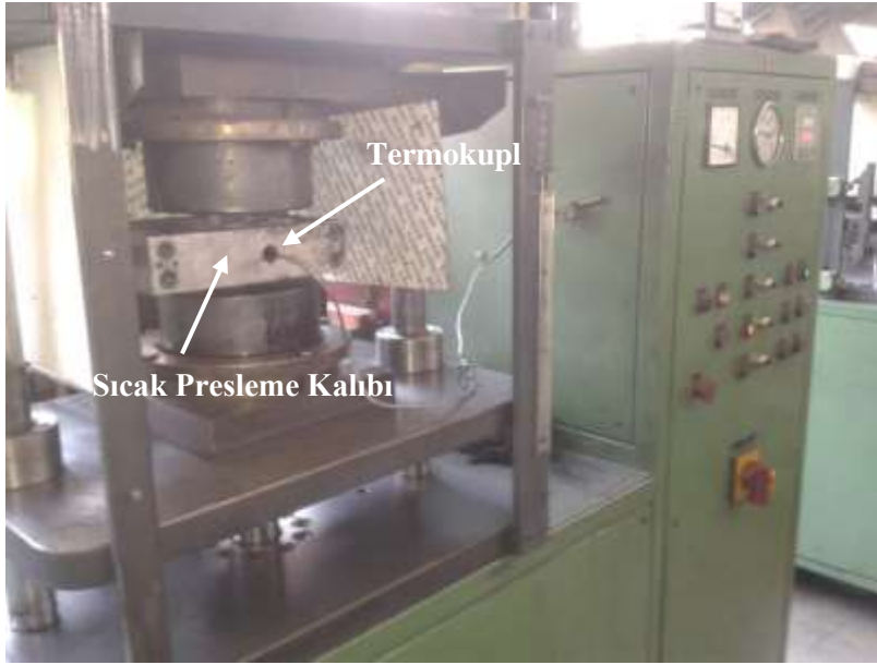
Resim 5.8. Endüstriyel tip sıcak presleme cihazı
