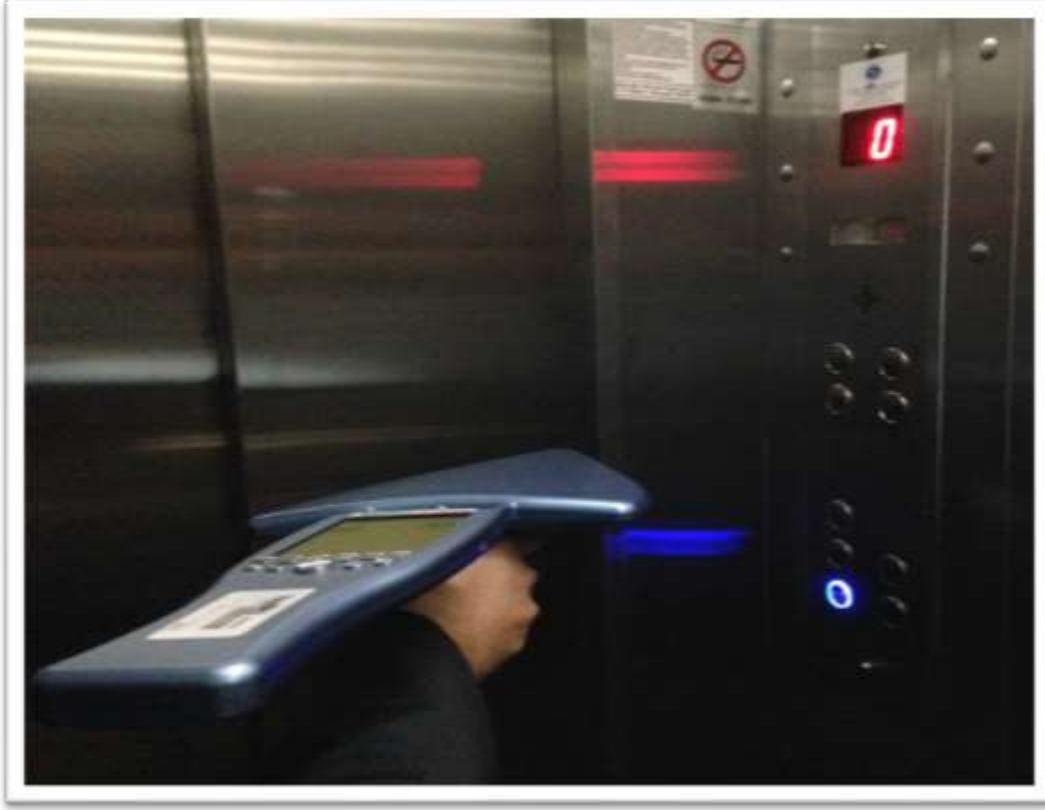
Şekil 7.8. 900 MHz 'de çalışan cep telefonlarında yapılan elektromanyetik alan ölçümü
