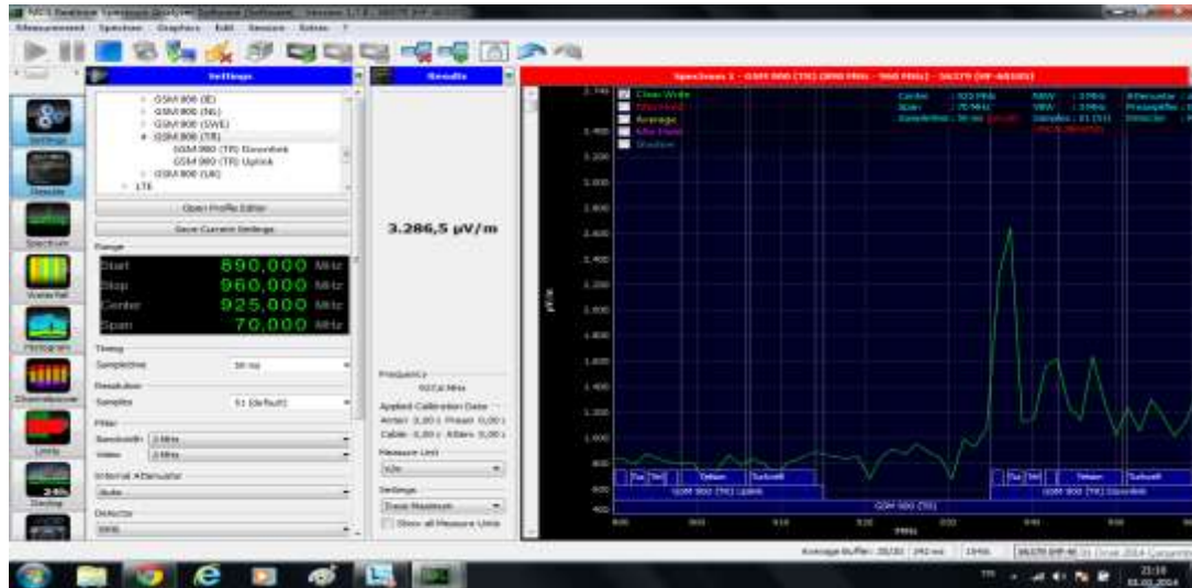
Resim 3.6. Uyku modunda çalışan cep telefonundan(900 MHz) elde edilen elektromanyetik alan ölçümü değeri
