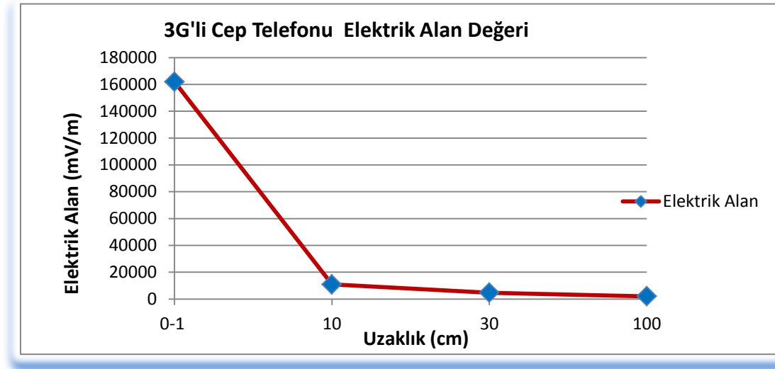
Şekil 7.11. Uzaklığa bağlı olarak 3G'li cep telefonu için elektrik alan değişimi
