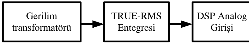
Şekil 5.2. Gerilim ölçüm sisteminin blok diyagramı
