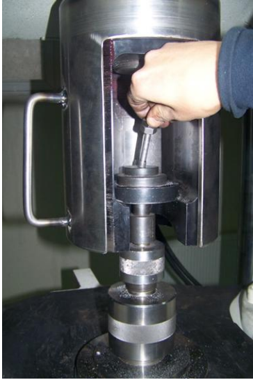
Resim 3.6. Tinius Olsen çekme testi cihazına çekme testi numunesinin yerleştirilmesi
