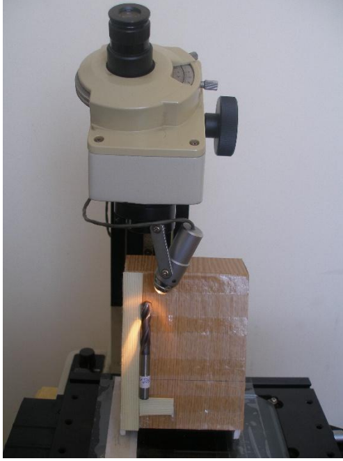
Resim 3.10. TiAlN kaplamalı karbür matkapta oluşan aşınma değerinin ölçümü
