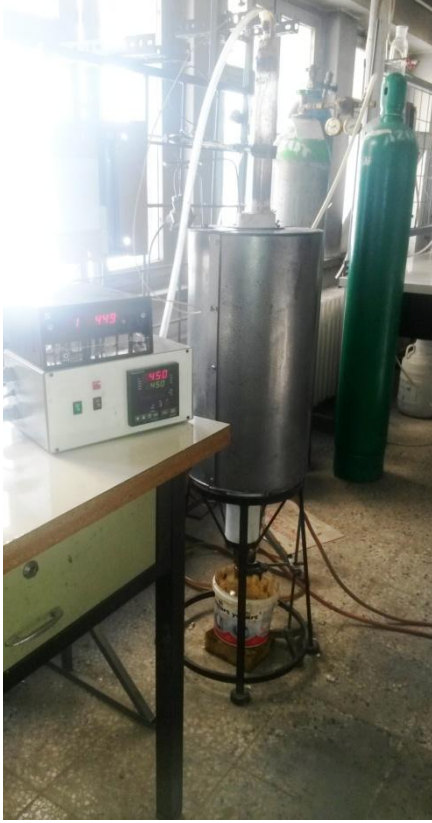
Resim 3.2. Laboratuvar ölçekli sabit yatakta retortlama deneyi düzeneği
