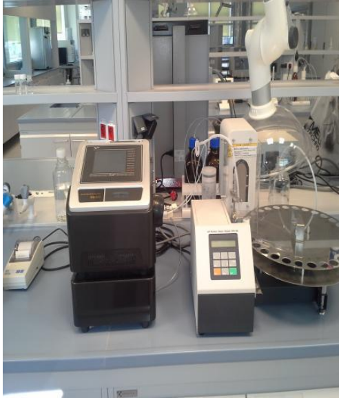
Resim 3.3. Yoğunluk tayini ve rölatif yoğunluk tayini cihazı
