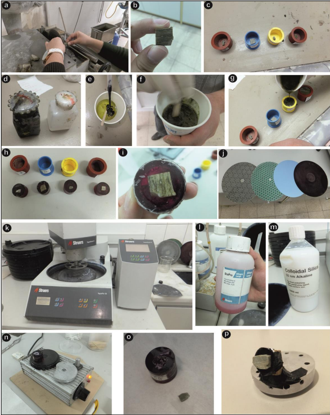
Şekil 2.2. EBSD analizi için örnek hazırlama aşamaları: (a, b) Örneklerin kaba kesme aletinde yaklaşık 1\text{cm}^2 'lik boyuta ve 4 mm kalınlığa getirilmesi (c) Plastik kalıpların alt kısmına örneğin parlatılacak kısmı gelecek şekilde konulması (d) Her örnek için ayrı ayrı 20 ml polyester içine 1 mg sertleştirici katılarak 1 dakika karıştırılması (e, f) 1 mg hızlandırıcı katılarak yine 1 dakika karıştırılması (g) Örneklerin üstüne hazırlanan karışımın dökülmesi (h, i) 45 dakika kuruması beklenen örneklerin plastik kalıplardan çıkarılması (j) Aşındırma sırasında kalından inceye doğru Piano, Largo, Tac ve Nap olarak adlandırılan zımparaların görüntüsü (k) Aşındırma ve parlatma işlemi için kullanılan cihazın
