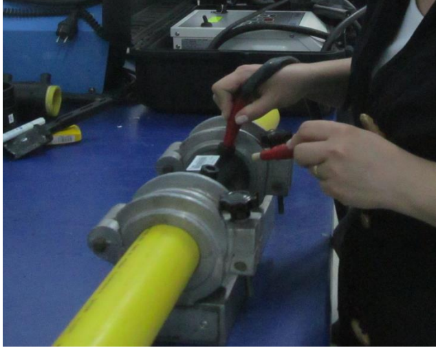
Resim 4.8. Elektrofüzyon makinesine kaynak işleminin gerçekleştirilmesi
