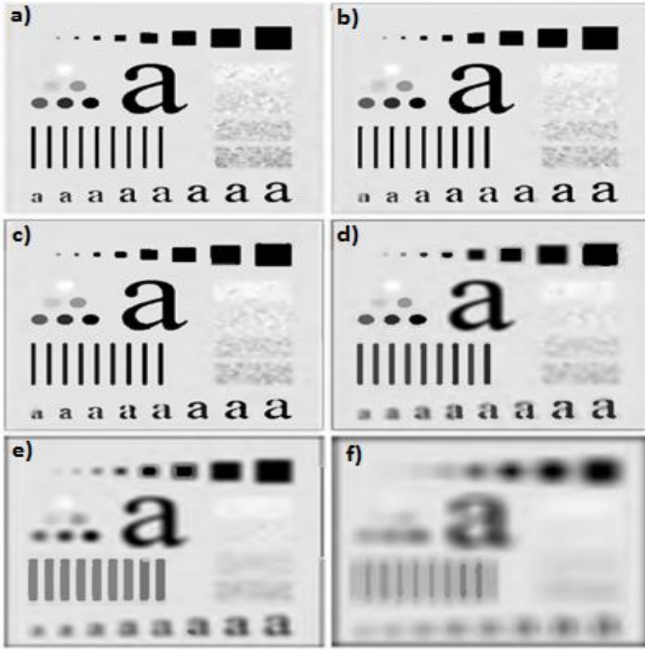
Resim 2.1 a) Asıl görüntü, 500x500 b) – f) kare ortalama filtre maskesi ile elde edilmiş düzeltilmiş filtre sonuçları
