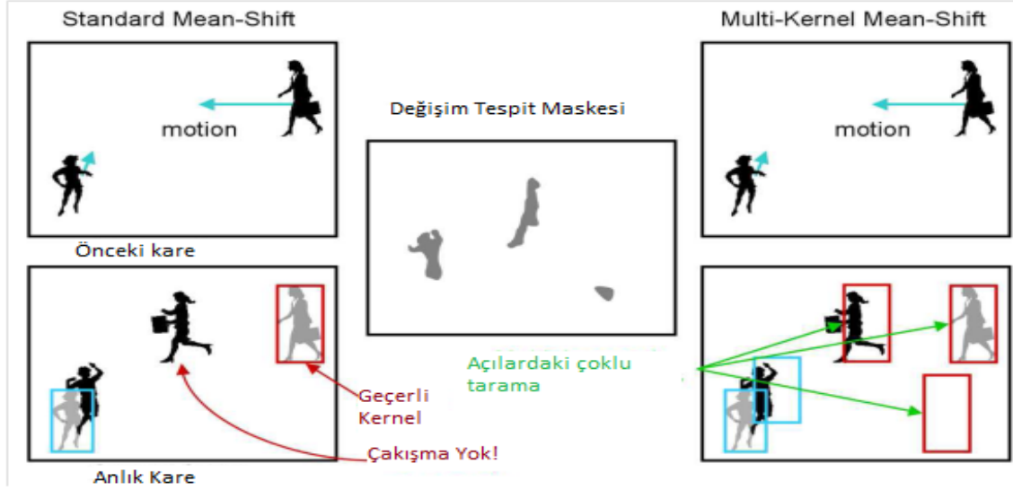
Şekil 4.3. Standart Mean-Shift ve çok merkezli Mean-Shift arasındaki farklar
