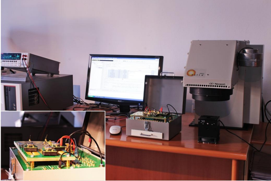
Resim 3.7. I-V ölçüm düzeneği (Keithley 4200 ve NewPort Oriel Sol1A)
