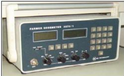
Resim 4.1. NE Teknoloji 2570/1 Farmer elektrometre
