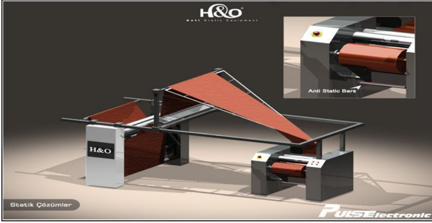
Şekil 6.3. Kumaş katlama makinesinde antistatik bar uygulaması
