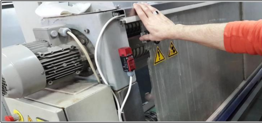
Resim 6.31. Ram makinesi kapaklarında sensörlü durdurma sistemi
