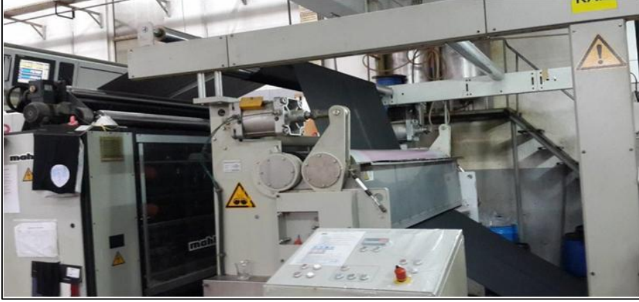
Resim 6.30. Ram makinesi silindirlerinin koruyucu kapakları
