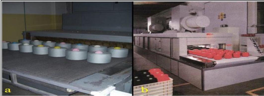
Resim 6.12. a)Taşıma bantlı bobin kurutma makinesi, b)Radyo frekanslı bobin kurutma makinesi
