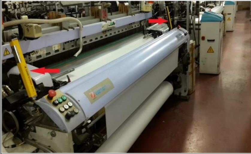
Resim 6.14. Düz dokuma makinesinde sensörlü koruma sistemi
