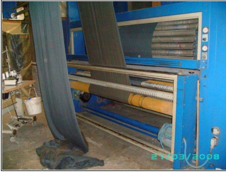
Resim 6.27. Kapağı açık şekilde çalışan şardon makinesi
