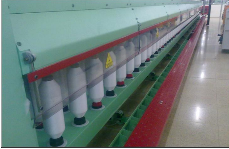
Resim 6.8. Fitol makinesinin Őeffaf siperlik koruyucusu
