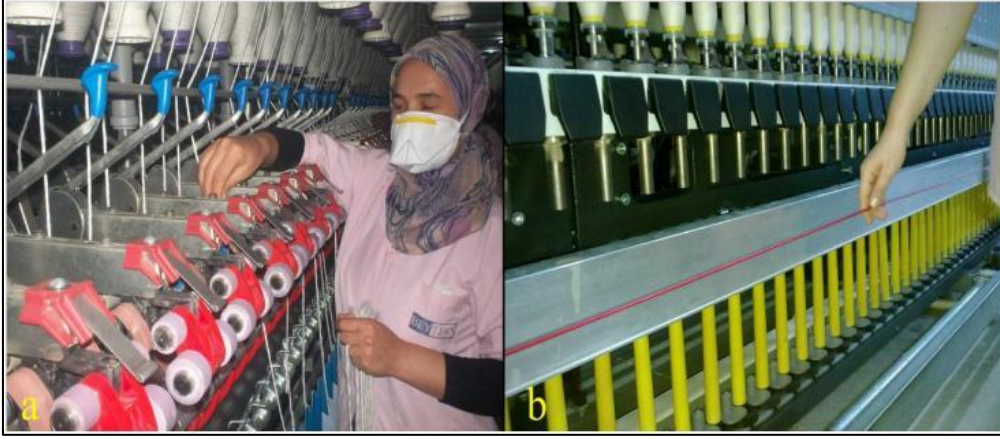
Resim 6.9. a)Ring iplik makinesinde apron ve manşonlar, b)Ring iplik makinesinde acil durdurma teli
