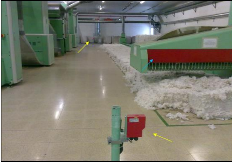
Resim 6.3. Tehlikeli alana girilmesi halinde balya yolucunun hareketini durduran fotosel tertibatı [2]
