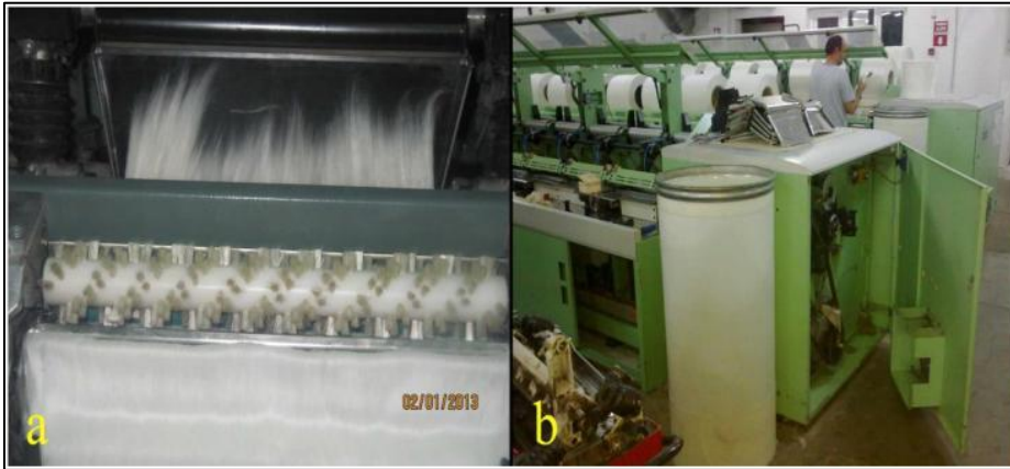
Resim 6.7. a)Penye makinesinde vuruş fırçaları (daireseel taraklar vuruş fırçalarının altında bulunmaktadır.) b)Kapağı açık durumda bulunan penye makinesi
