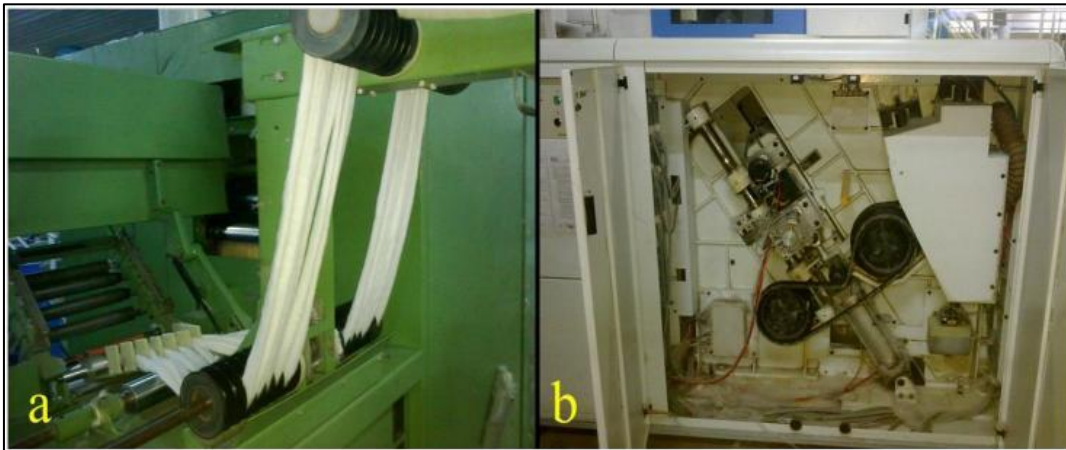
Resim 6.6. a)Vatka makinesinde döner aksamlar, b)Kapağı açık durumda bulunan vatka makinesi ve kayış kasnak mekanizması
