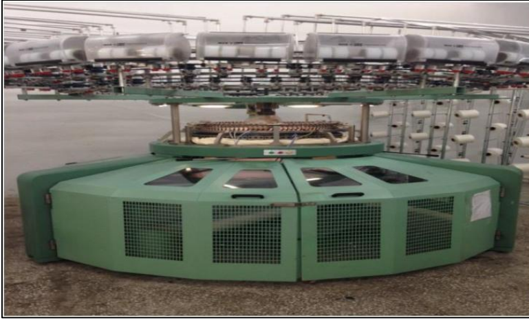
Resim 6.16. Kapağında siviç bulunan yuvarlak örme makinesi
