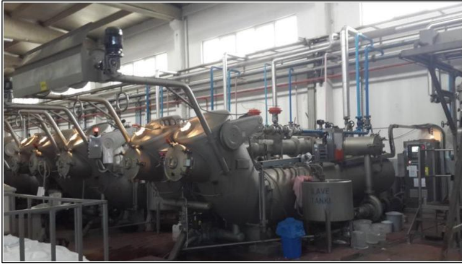
Resim 6.22. Jet boyama makineleri ve kimyasal ilave tankı
