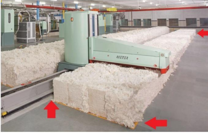
Resim 6.2. Çalışma alanı belirlenmiş fakat fotosel tertibatı bulunmayan otomatik balya açma makinesi
