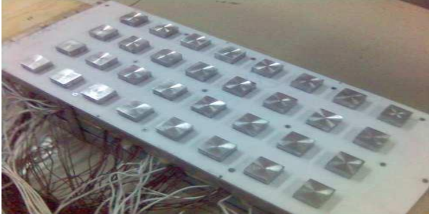
Resim 3.2. Test bölgesindeki alüminyum ısıtıcı bloklar
