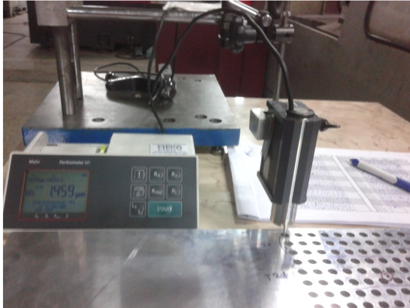
Resim 6.6. Yüzey pürüzlülük ölçme cihazı ile ölçümlerin yapılması
