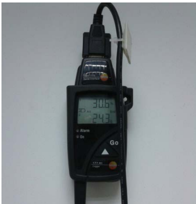
Resim 6.4. Veri ağına bağlı ortam sıcaklık ölçer
