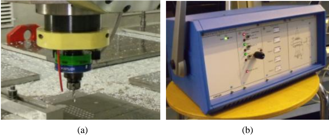
Resim 6.2. Tezgaha entegre edilmiş Kistler dönel tip dinamometre (a) ve kontrol ünitesi(b)
