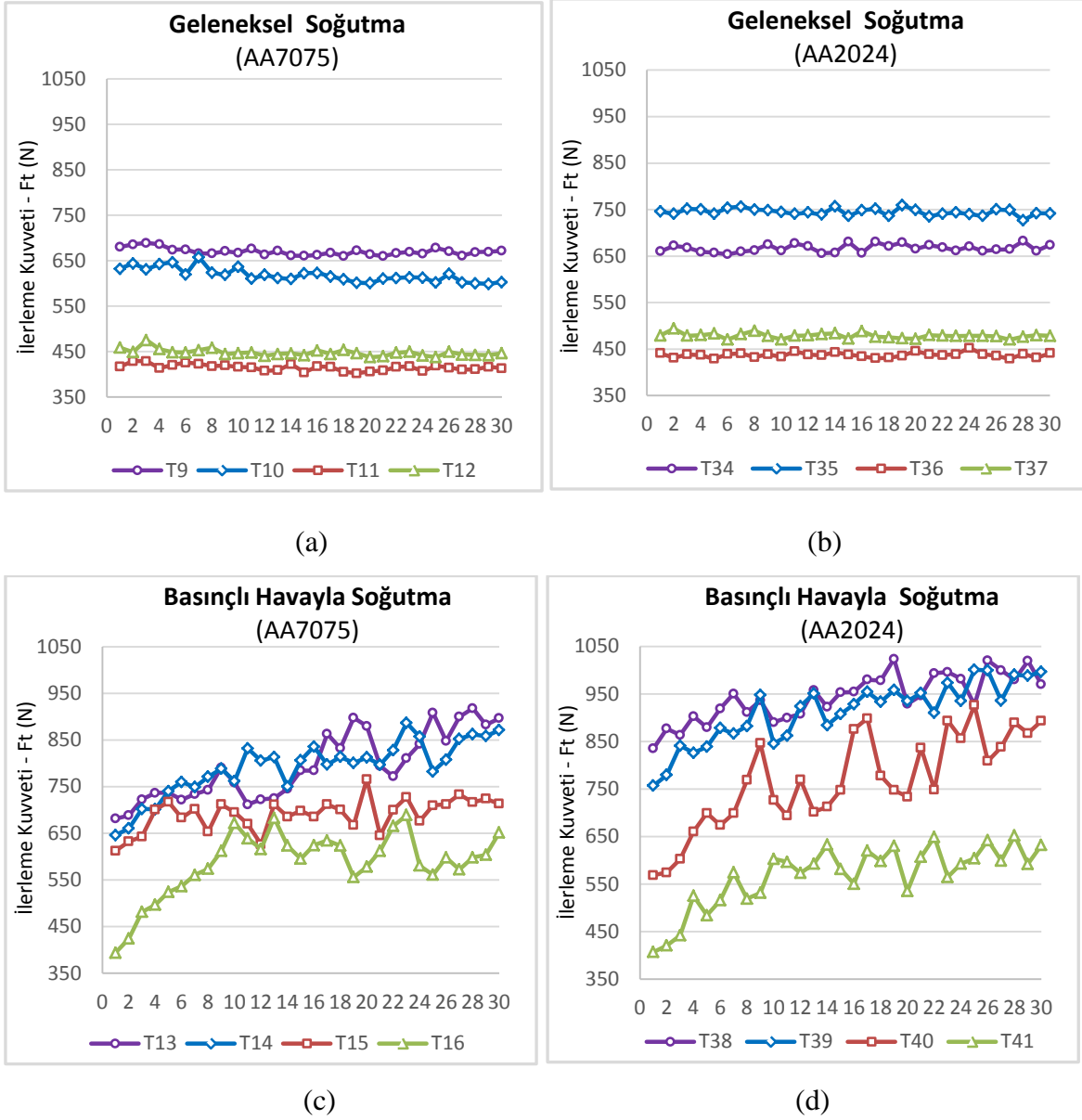
Şekil 7.41. AA7075 ve AA2024 alaşımlarının farklı soğutma şartlarında delinmesinde 1. delikten 30. deliğe doğru takımlara etkiyen ilerleme kuvvetlerindeki değişimler.
