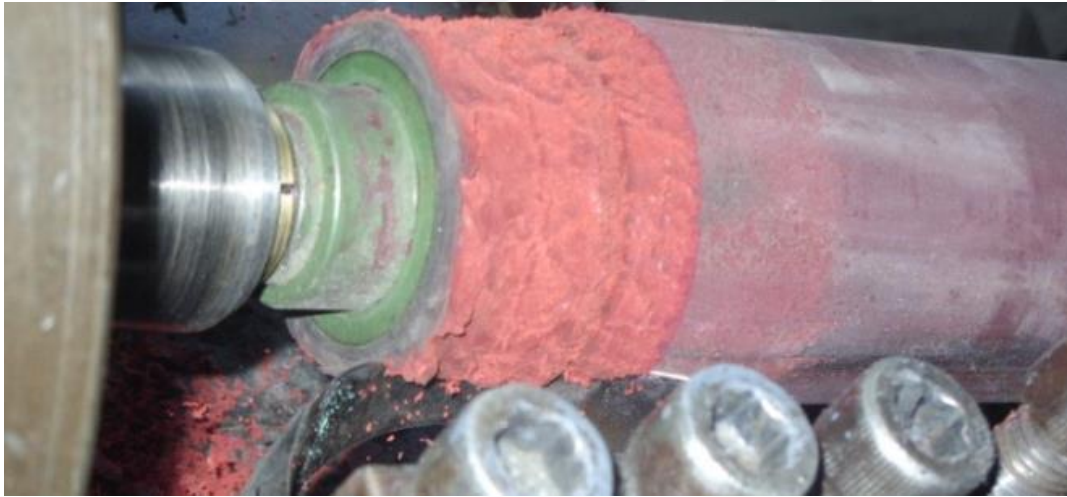
Resim 2.2. Hasarlı olan millerin soyulma işlemi
