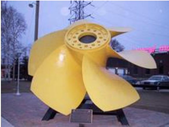
Şekil 2.9. Kaplan tipi türbinin kanatları [35]
