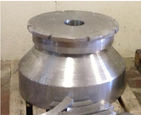
Şekil 2.6. Yapım aşamasında olan Francis tipi türbin
