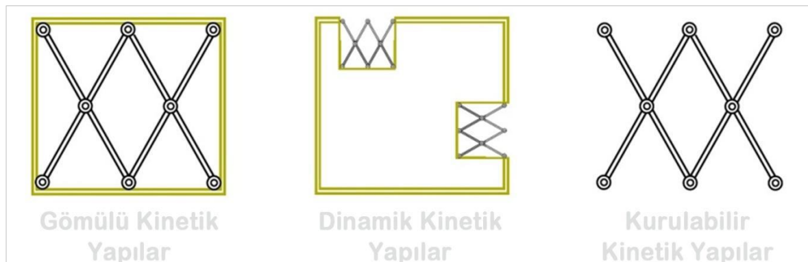
Şekil 2.9. Kinetik yapıların sınıflandırılması [21]
