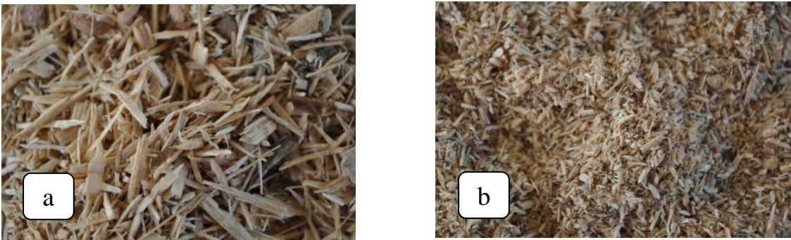
Resim 4.3. (a) Orta tabakada kullanılan çam yongaları (b) Yüzey tabakada kullanılan çam yongaları
