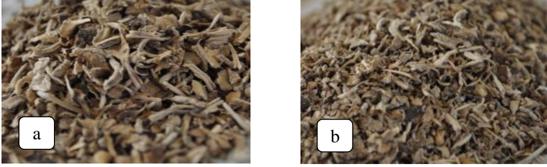
Resim 4.2. (a) Orta tabakada kullanılan haşhaş yongaları, (b) Yüzey tabakada kullanılan haşhaş yongaları
