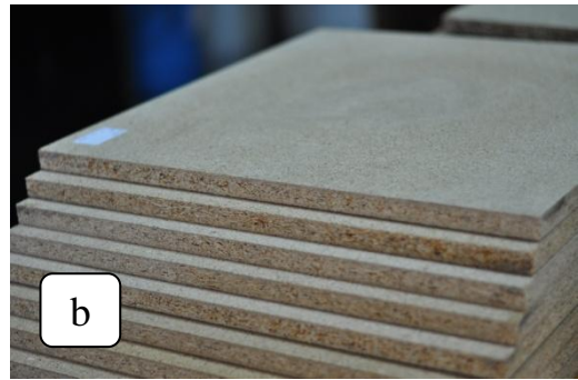
Resim 4.6. (a) %100 haşhaş yongasıyla üretilen levhalar, (b) %100 çam yongasıyla üretilen levhalar
