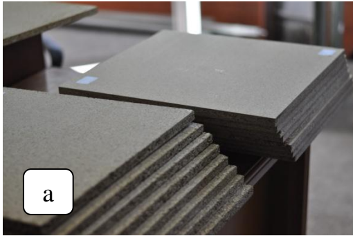
Resim 4.6. (a) %100 haşhaş yongasıyla üretilen levhalar, (b) %100 çam yongasıyla üretilen levhalar
