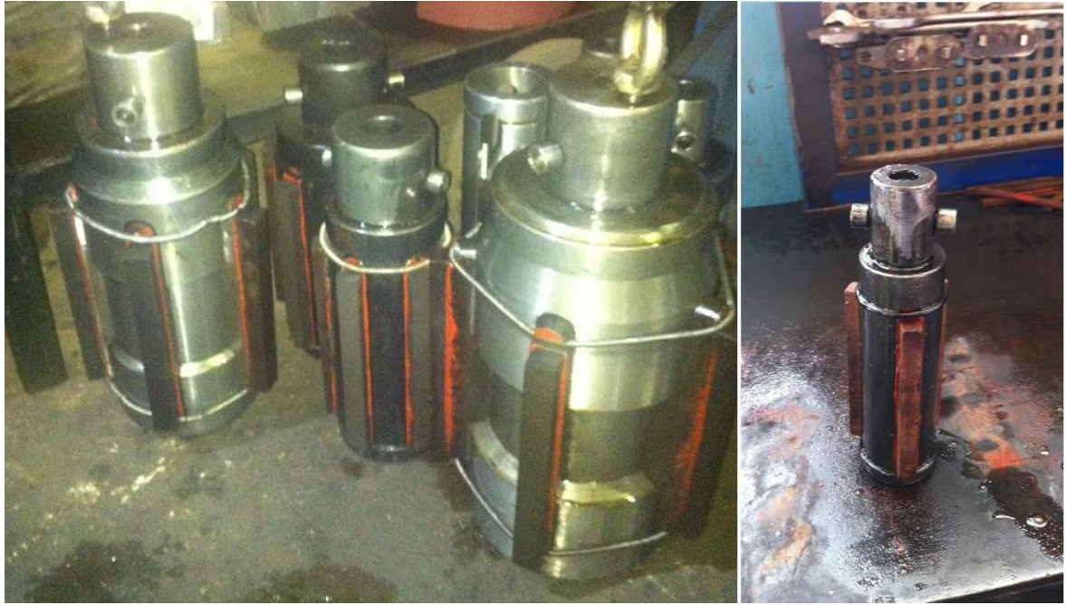
Resim 2.5. Değişik çaplarda honlama kafaları ve honlama taşlarının yerleşimi
