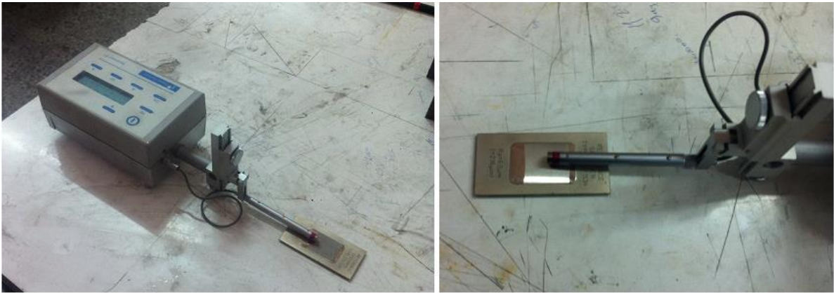
Resim 4.13. Yüzey pürüzlülük ölçüm cihazı kalibrasyonu
