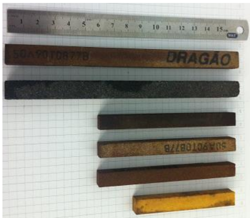
Resim 2.15. İşletmede yoğunlukla kullanılan honlama taşı örnekleri
