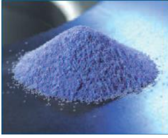
Resim 2.18. Mikrokristal Cürüflu Korund
