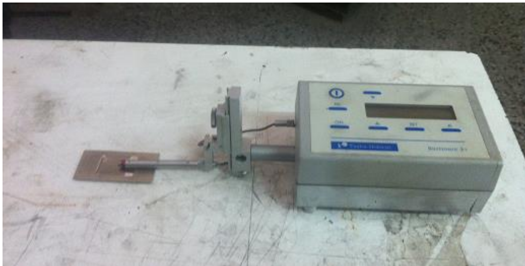
Resim 4.8. Taylor Hobson Surtronic 3 yüzey pürüzlülük ölçüm cihazı
