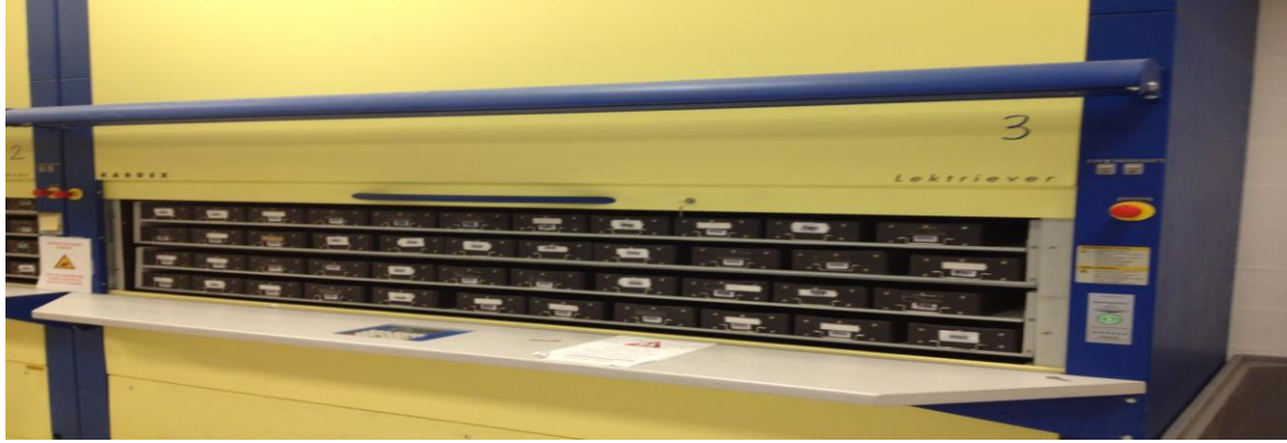
Resim 4.2. Otomatik stoklama kabininde tepsi bölmeleri
