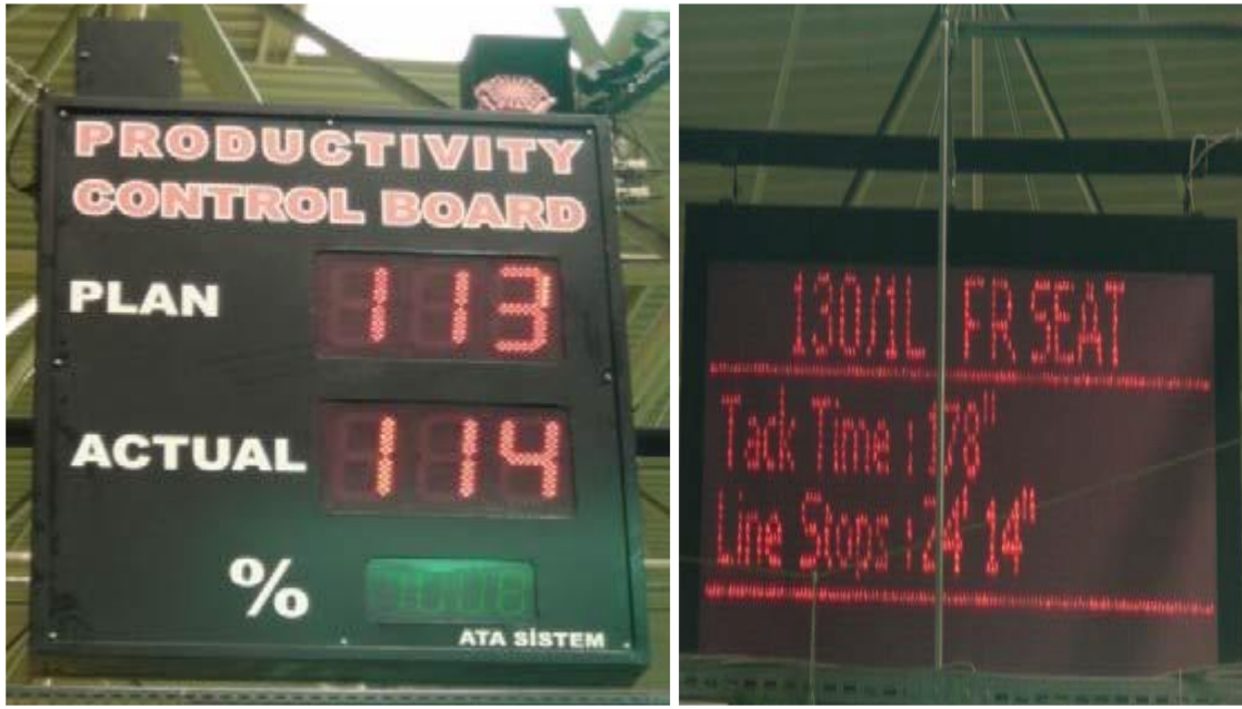
Resim 2.1. Görsel kontrolde kullanılan panolar [Toyota Boshoku Fabrikası]
