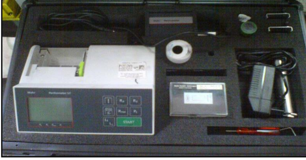
Resim 4.1. Mahr Perthometer M1 yüzey pürüzlülüğü ölçüm cihazı
