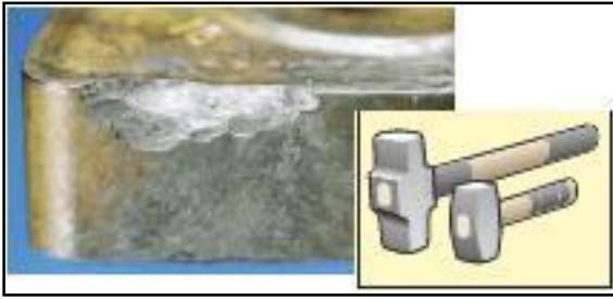
Resim 3.7. Kesici uçta kırılma (Sandvik Coromant, 2015)
