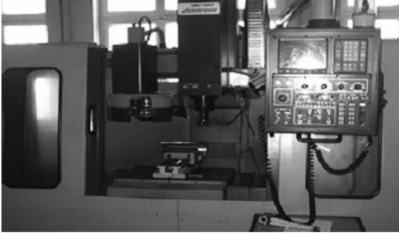
Resim 4.3. Johnford VMC-550 CNC dik işleme merkezi
