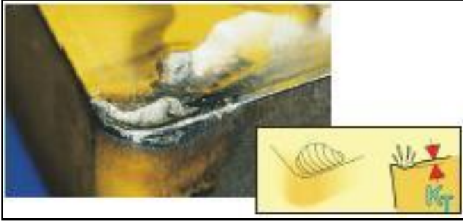
Resim 3.2. Kesici uçtaki krater aşınması (Sandvik Coromant, 2015)
