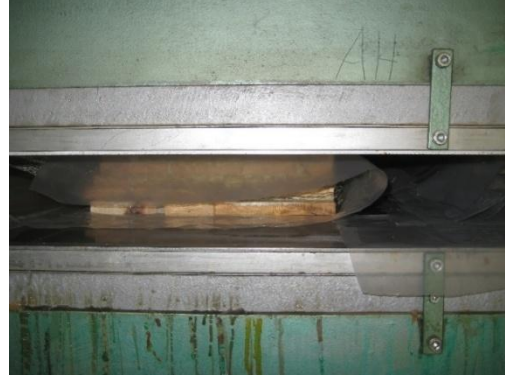
Resim 4.3. Lamine ahşap yapı elemanlarının preslenmesi
