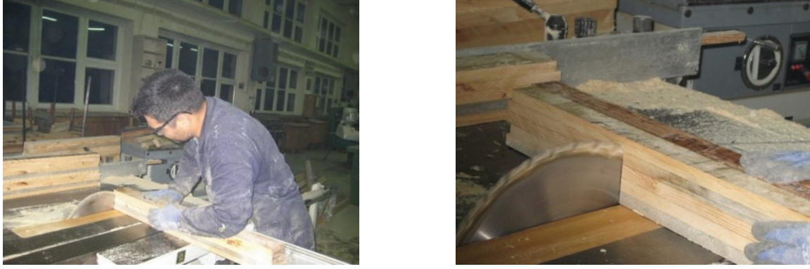
Resim 4.6. Eğilme mukavemeti ve liflere paralel basınç mukavemeti tayini için kullanılacak numunelerin daire testerede boy ölçülendirilmesi.
