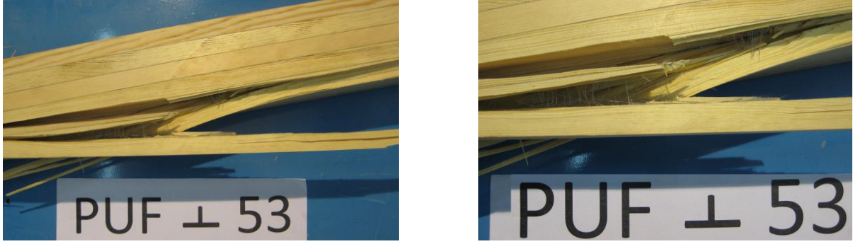
Resim 6.1. Fiberglas tel örgü ile desteklenmiş numunelerin kırılma şekli
