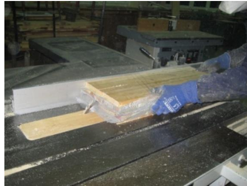
Resim 4.5. Liflere paralel basınç mukavemeti tayini için kullanılacak numunelerin daire testerede en ölçülendirilmesi.
