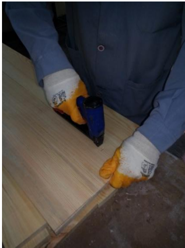
Resim 4.2. Lamellerin düz en birleştirme yapılan bölgelerine U çivi çakılması
