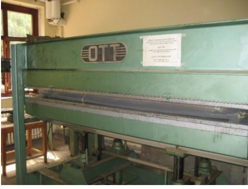
Resim 4.3. Lamine ahşap yapı elemanlarının preslenmesi
