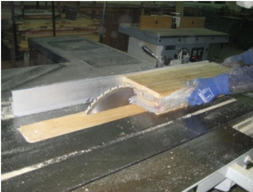
Resim 4.5. Liflere paralel basınç mukavemeti tayini için kullanılacak numunelerin daire testerede en ölçülendirilmesi.
