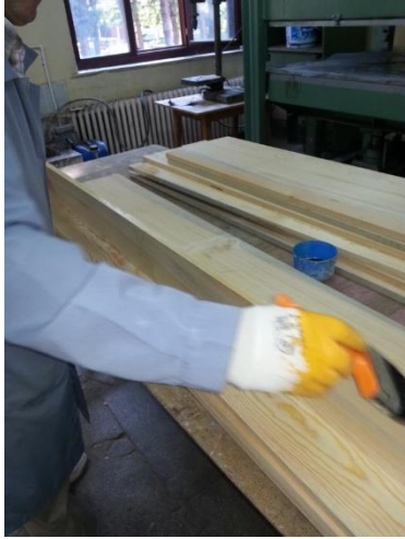
Resim 4.1. Düz en birleştirme yapılan lameller
