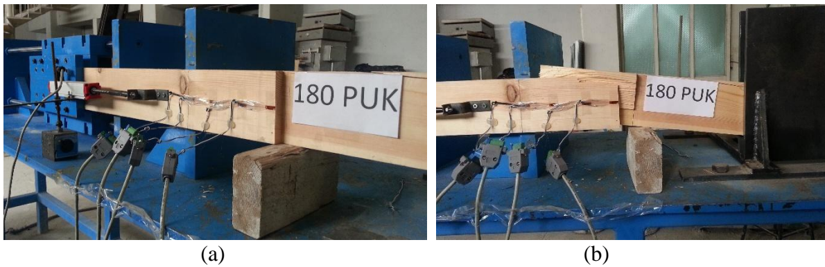
Resim 4.13. (a) Yapışma mukavemeti tayini uygulanan numune ve (b) kırılma şekli.
