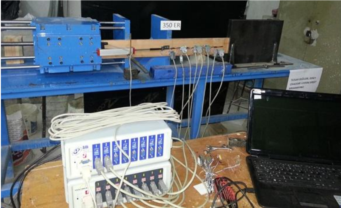
Resim 4.12. Yapışma mukavemeti numunesi, LVDT, yük hücresi ve veri toplama cihazı bağlantısı
