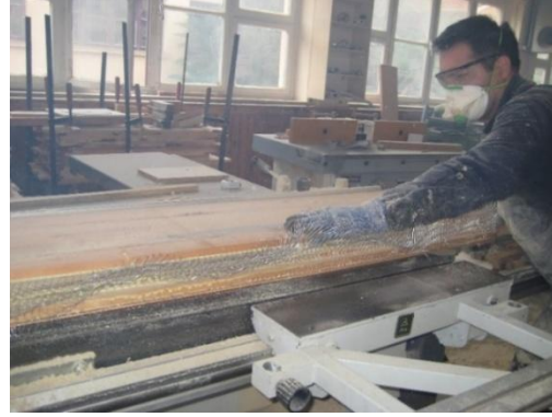
Resim 4.4. Eğilme mukavemeti tayini için kullanılacak numunelerin daire testerede en ölçülendirilmesi.
