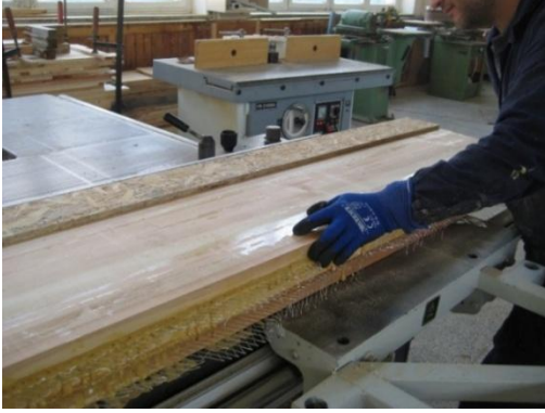
Resim 4.4. Eğilme mukavemeti tayini için kullanılacak numunelerin daire testerede en ölçülendirilmesi.
