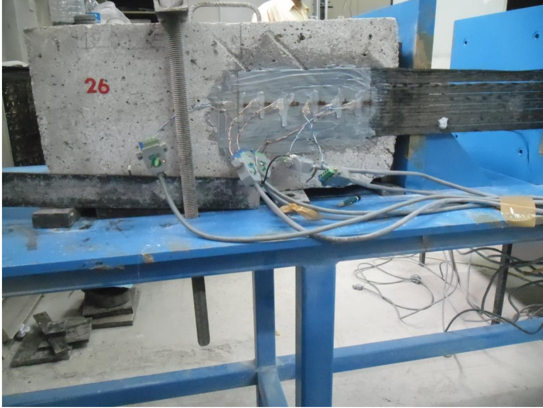
Resim 5.48. Deney elemanı 100W200L2S göçmeden önceki görünüşü
