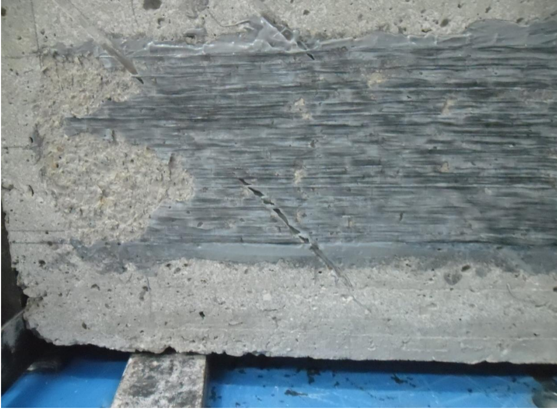
Resim 5.55. Deney elemanı 100W280L2S göçmeden sonraki görünüşü
