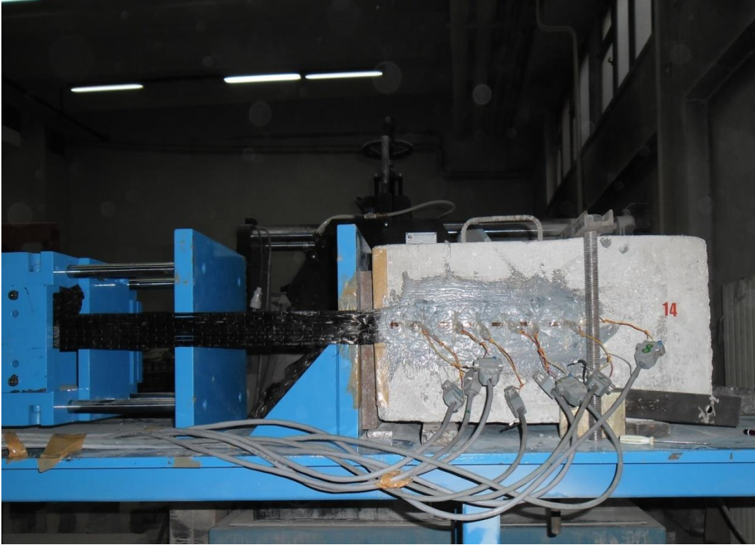
Resim 5.24. Deney elemanı 50W280L3A göçmeden önceki görünüşü
