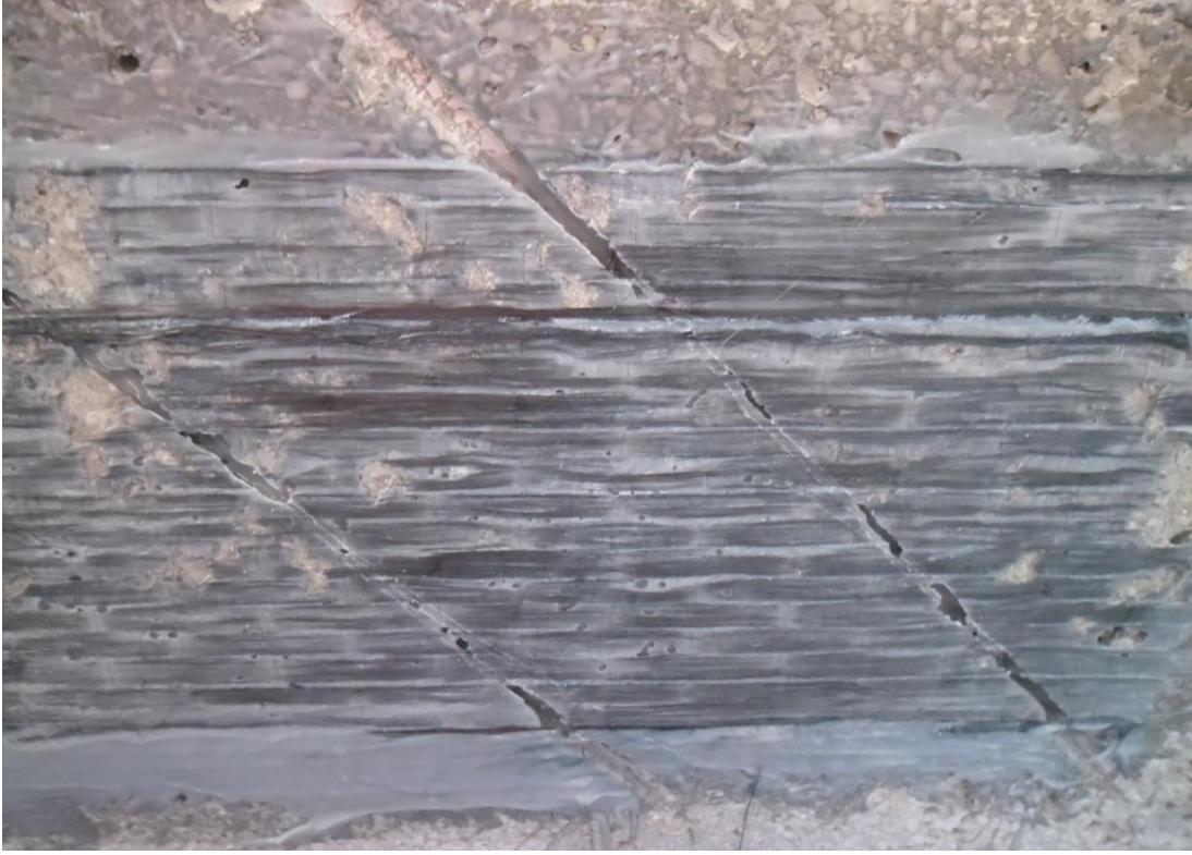
Resim 5.49. Deney elemanı 100W200L2S göçmeden sonraki görünüşü
