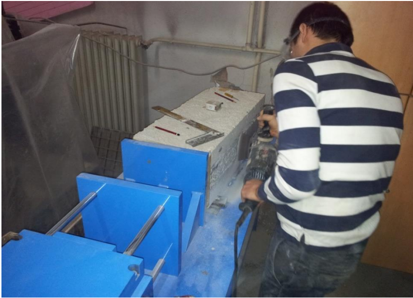
Resim 3.4. Deney elemanı yüzey hazırlığı
