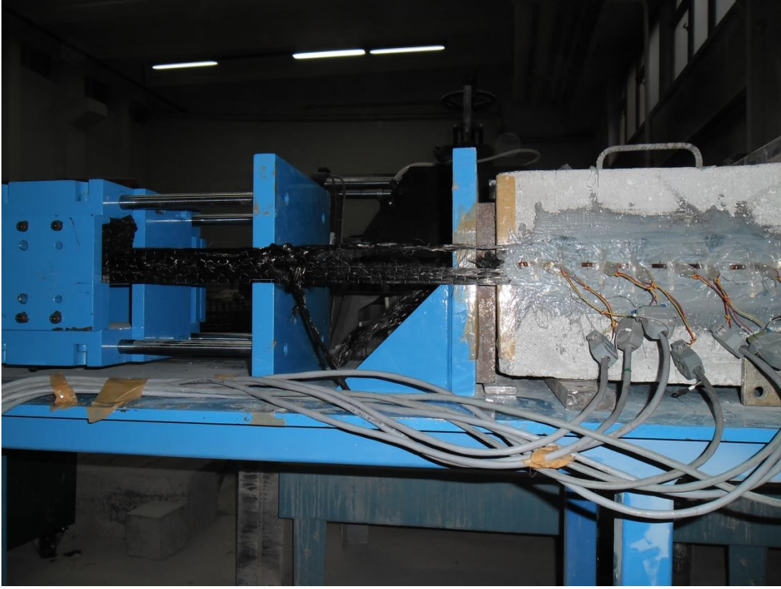
Resim 5.25. Deney elemanı 50W280L3Agöçmeden sonraki görünüşü
