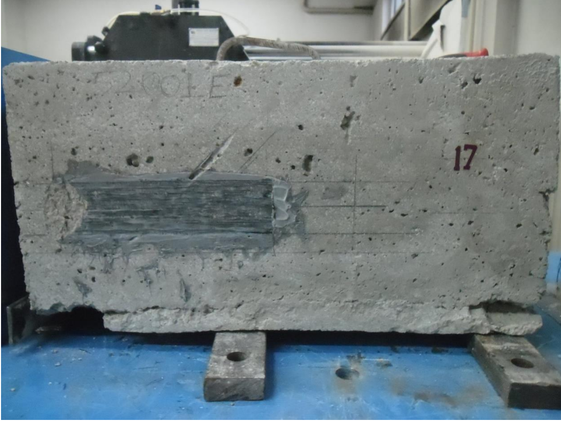
Resim 5.31. Deney elemanı 50W200L1S göçmeden sonraki görünüşü
