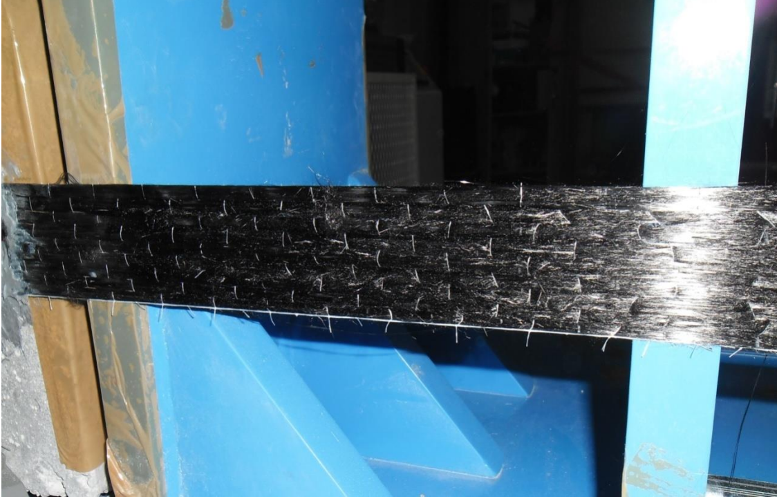
Resim 5.12. Deney elemanı 50W280L2A göçmeden sonraki görünüşü
