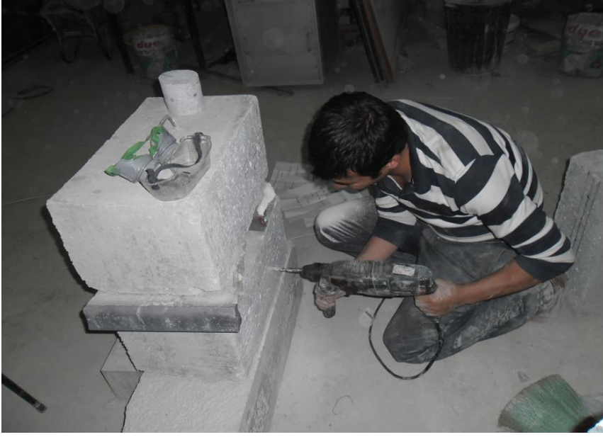
Resim 3.6. Deney elemanı yüzey hazırlığı
