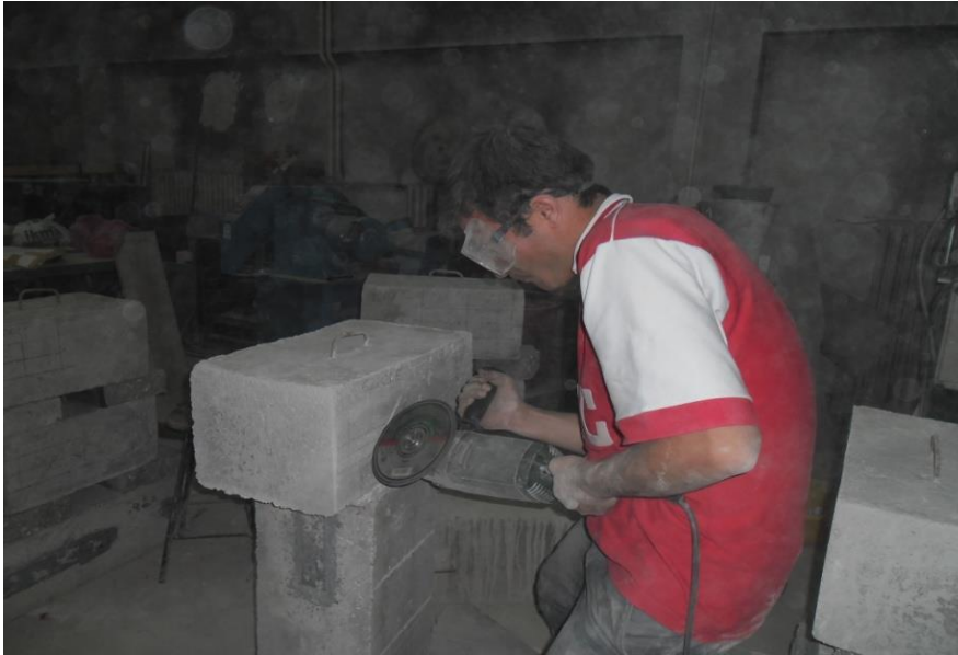
Resim 3.7. Deney elemanı yüzey hazırlığı
