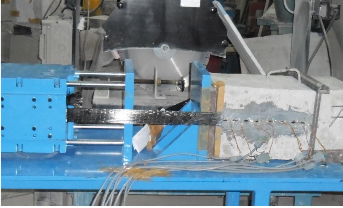
Resim 5.9. Deney elemanı 50W280L1A göçmeden önceki görünüşü
