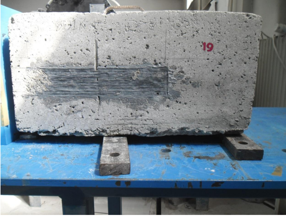
Resim 5.35. Deney elemanı 50W280L1F göçmeden sonraki görünüşü
