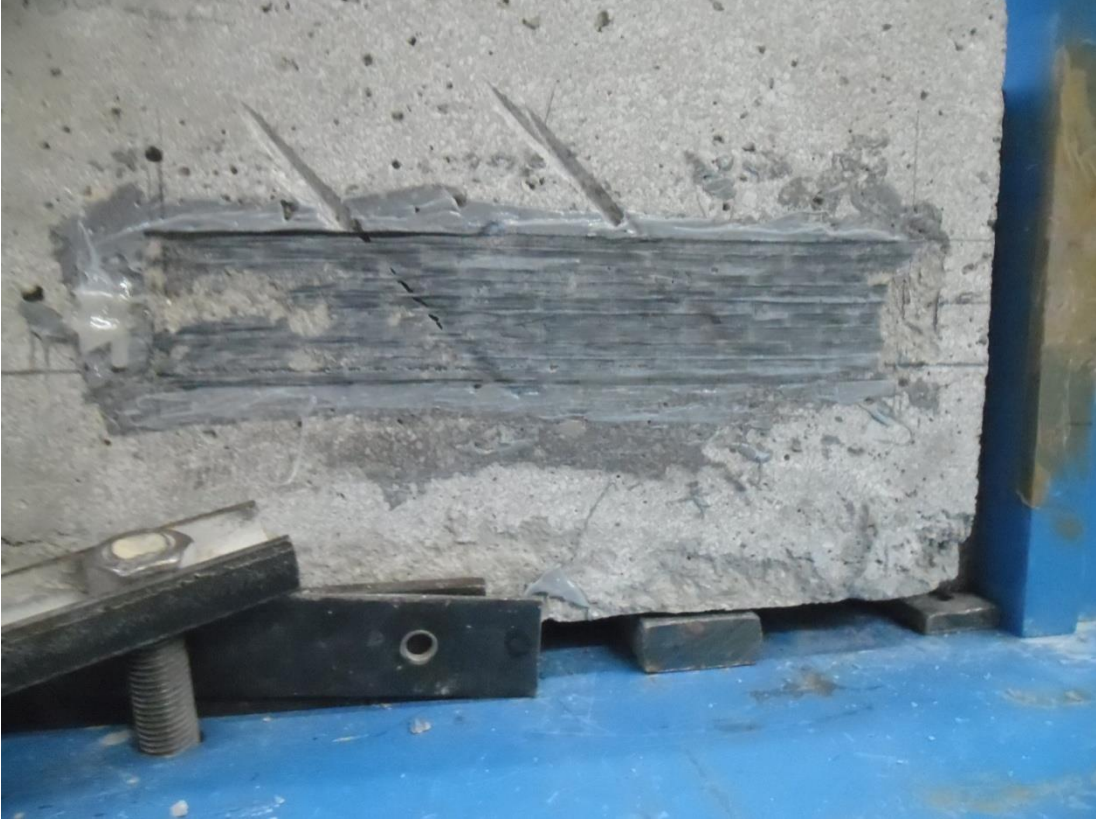
Resim 5.41. Deney elemanı 50W280L2S göçmeden sonraki görünüşü
