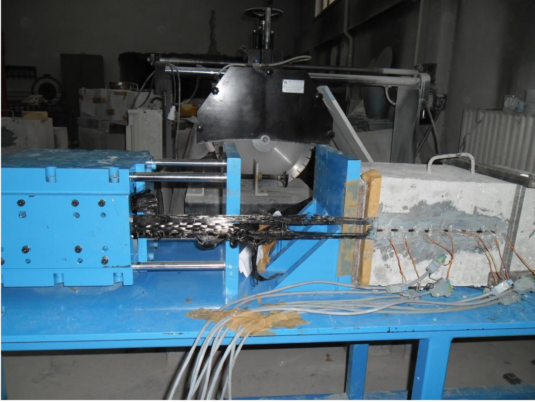
Resim 5.10. Deney elemanı 50W280L1Agöçmeden sonraki görünüşü
