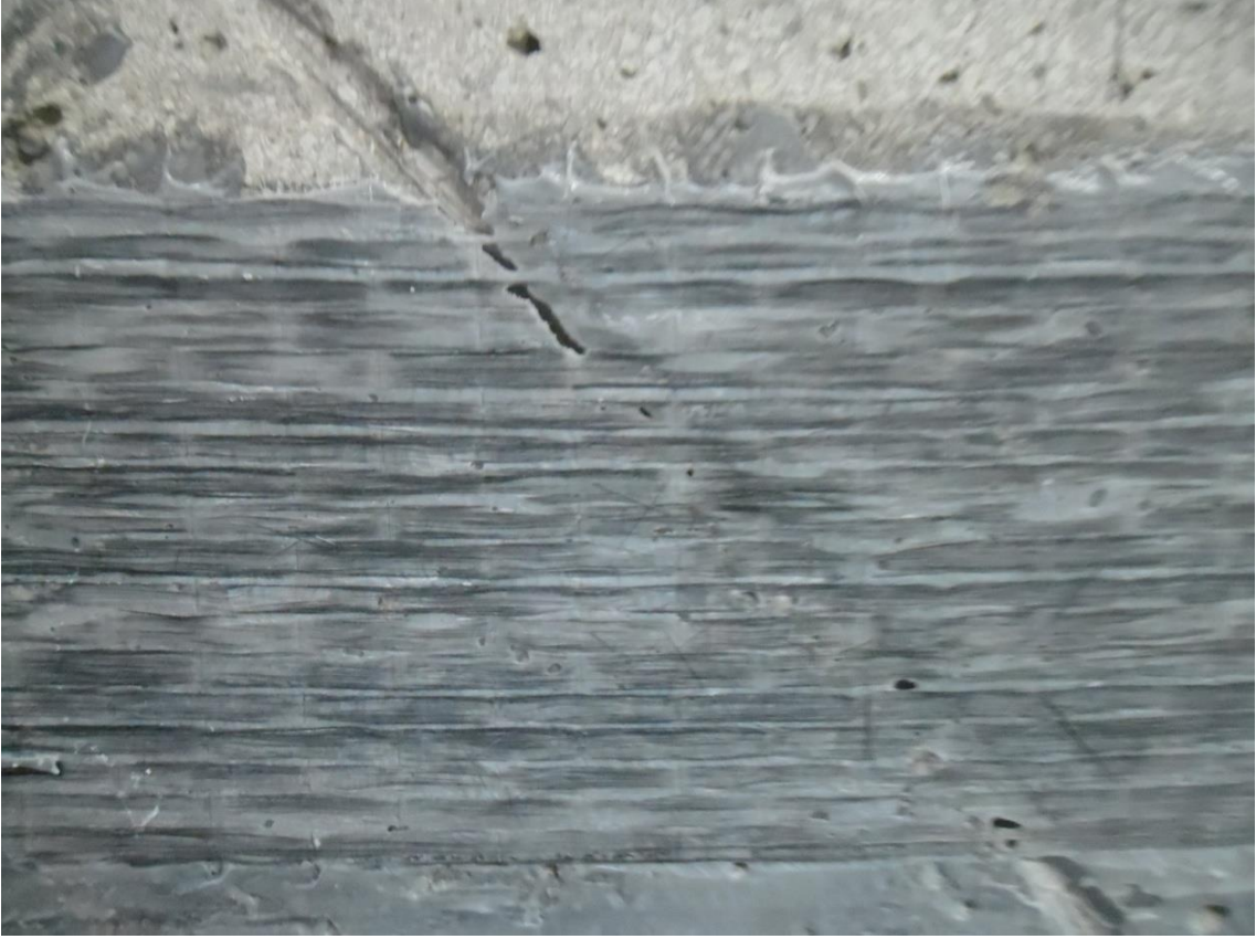
Resim 5.57. Deney elemanı 100W280L1S göçmeden sonraki görünüşü
