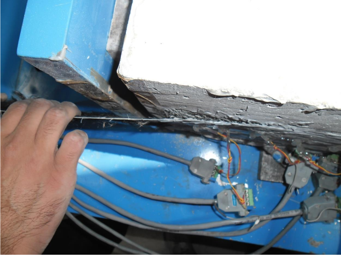
Resim 5.14. Deney elemanı 100W200L1A göçmeden sonraki görünüşü
