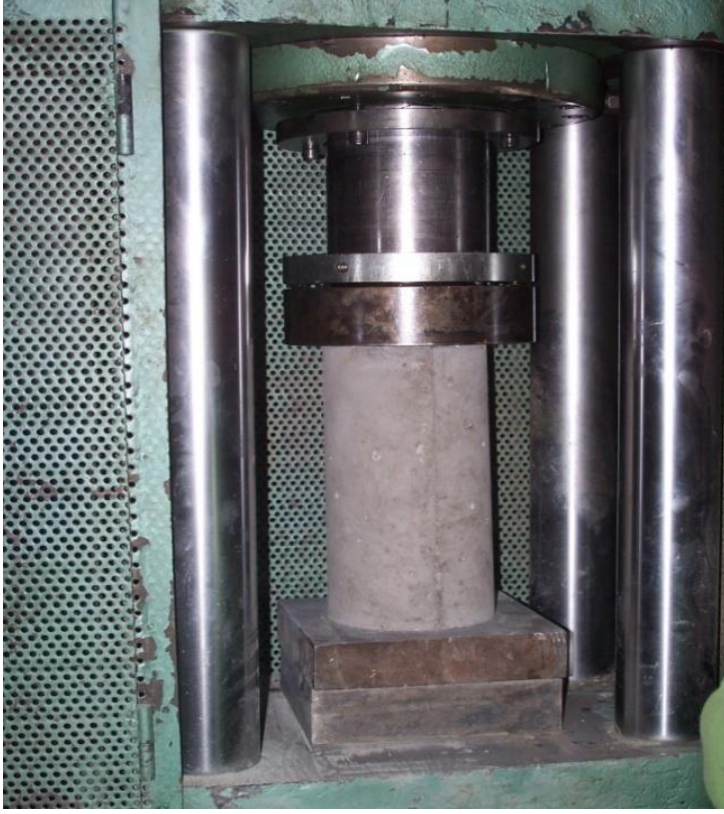
Resim 3.2. Standart silindir numune testi
