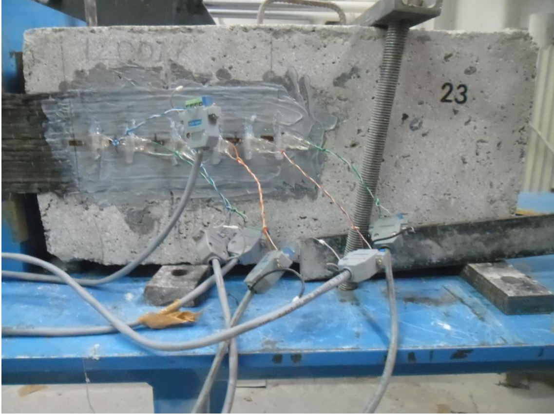
Resim 5.42. Deney elemanı 100W200L1F göçmeden önceki görünüşü
