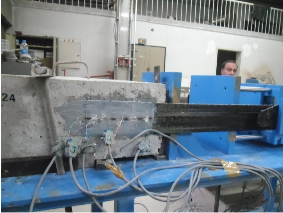
Resim 5.44. Deney elemanı 100W200L2F göçmeden önceki görünüşü
