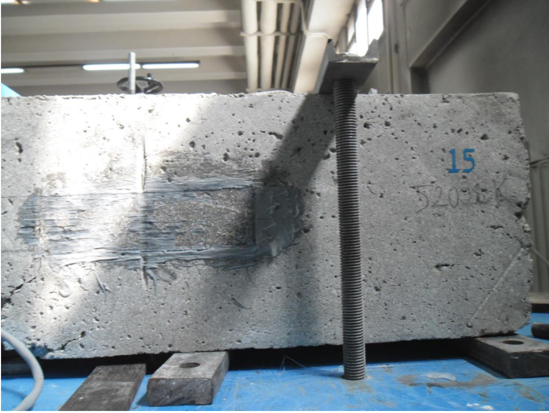
Resim 5.27. Deney Elemanı 50W200L1F göçmeden sonraki görünüşü
