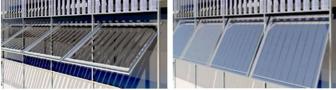
Resim 3.17. Deneysel PV entegreli panjur sistemi [46]
