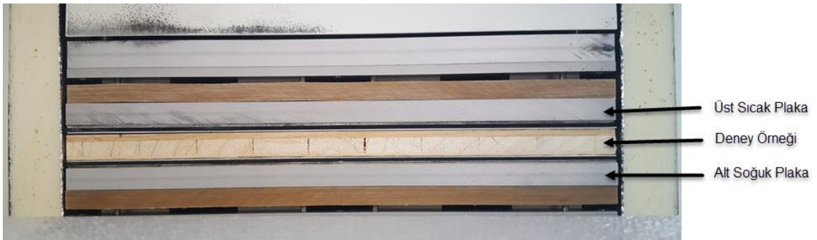
Resim 4.7. Isı iletkenlik ve ısı geirgenlik deney cihazı plakaları
