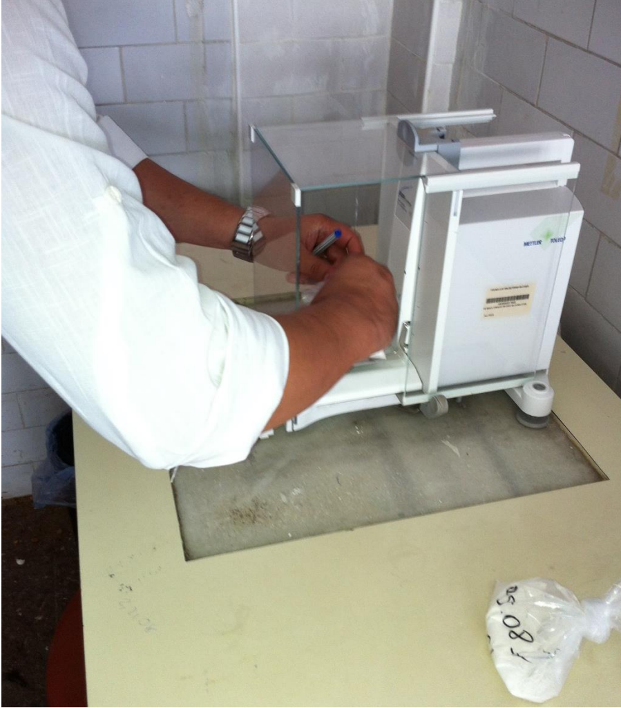
Resim 5.6. Elde edilen kristalin miktarının ölçülmesi
