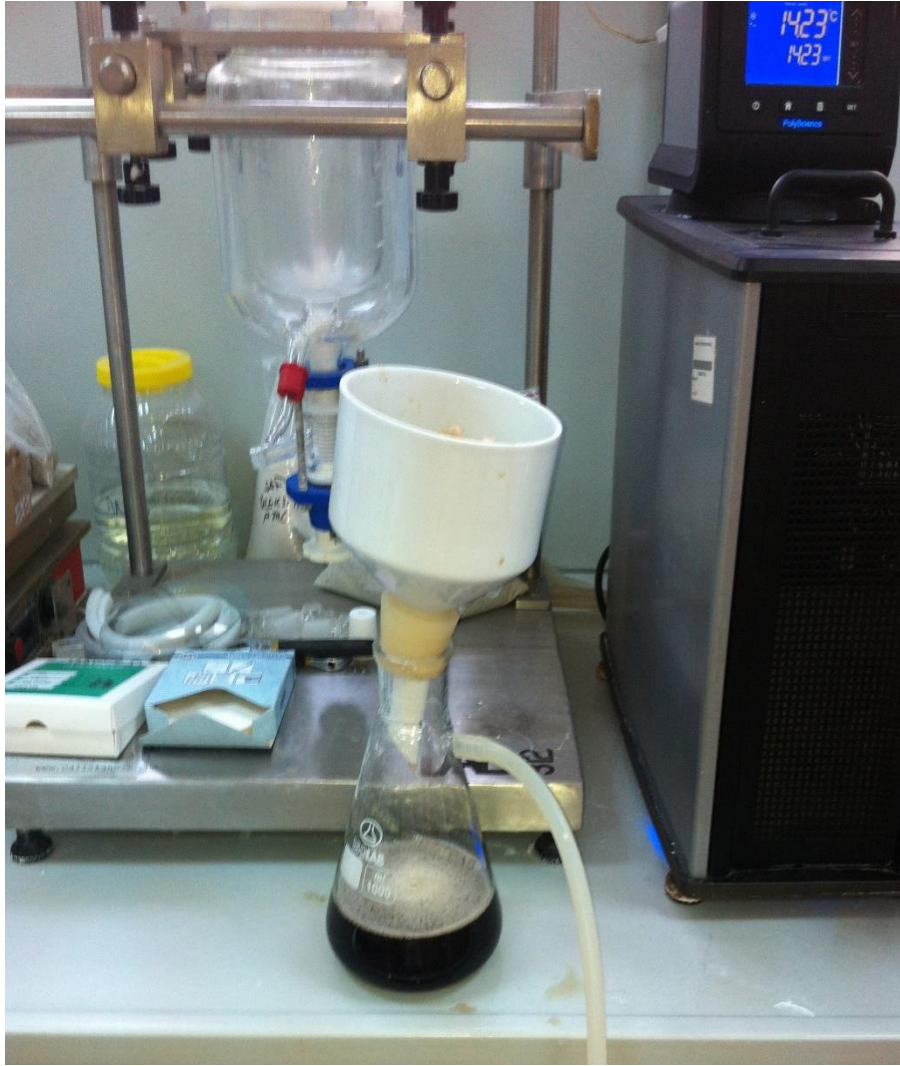
Resim 5.5. Vakum pompası ile kristallerin süzülmesi
