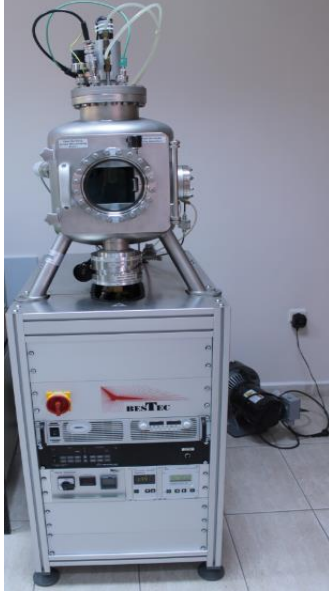
Resim 3.5. Termal buharlaştırma sistemi (Gazi Fotonik)
