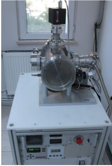
Resim 3.6. Hızlı tavlama sistemi (RTA) (Gazi Fotonik)
