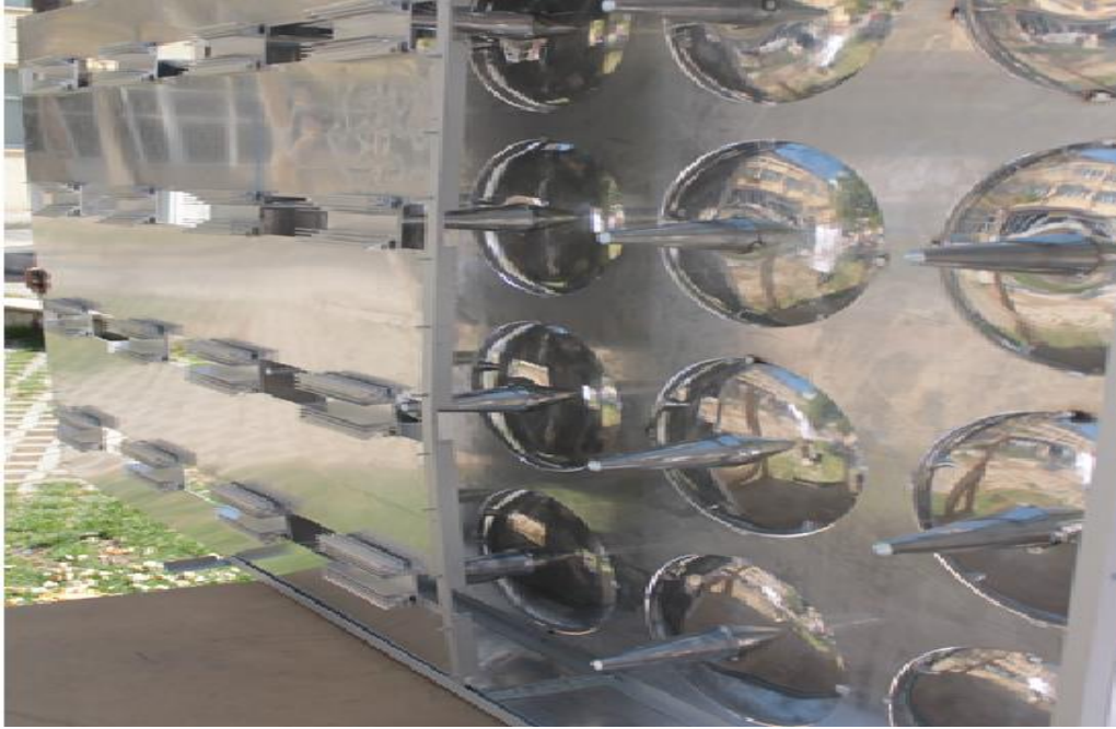
Resim 5.10. 16'lı parabolik yoğunlaştırıcı prototip sistemin arka yüzey görünüşü
