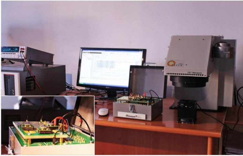
Resim 6.1. I-V ölçüm düzeneği (Gazi Fotonik)
