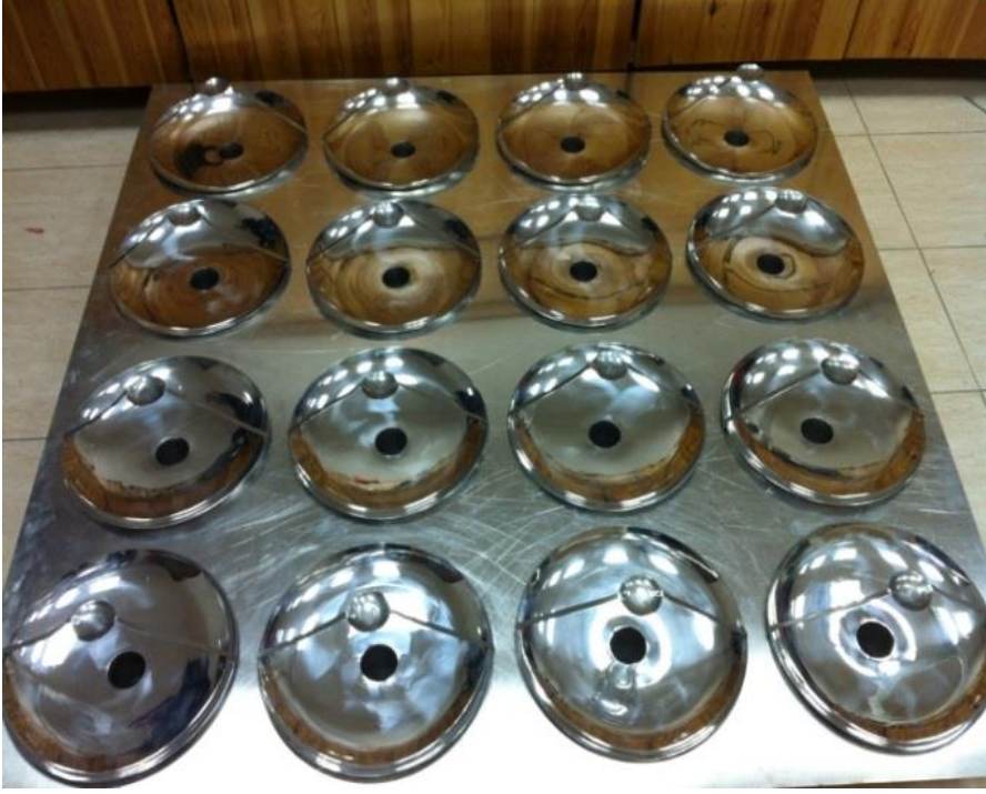
Resim 5.7. 16'lı parabolik yoğunlaştırıcı optik modülün ön yüzeyi
