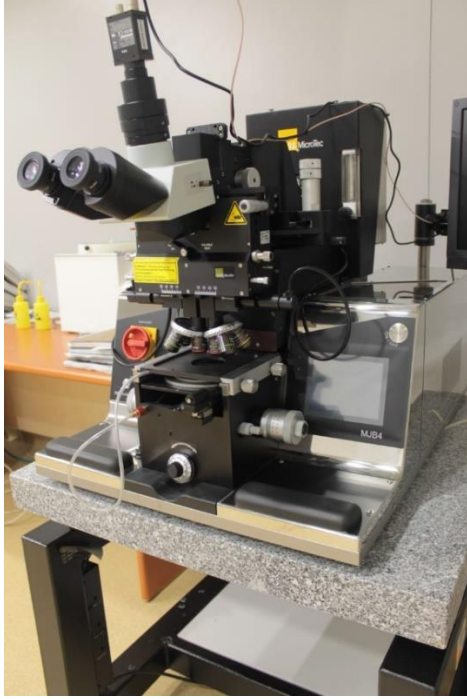
Resim 3.4. SUSS Micro Tech-MJB4 model maske hizalama sistemi (Gazi Fotonik)
