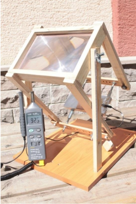
Resim 5.2. Fresnel merceğin odak noktasında oluşan sıcaklık değeri
