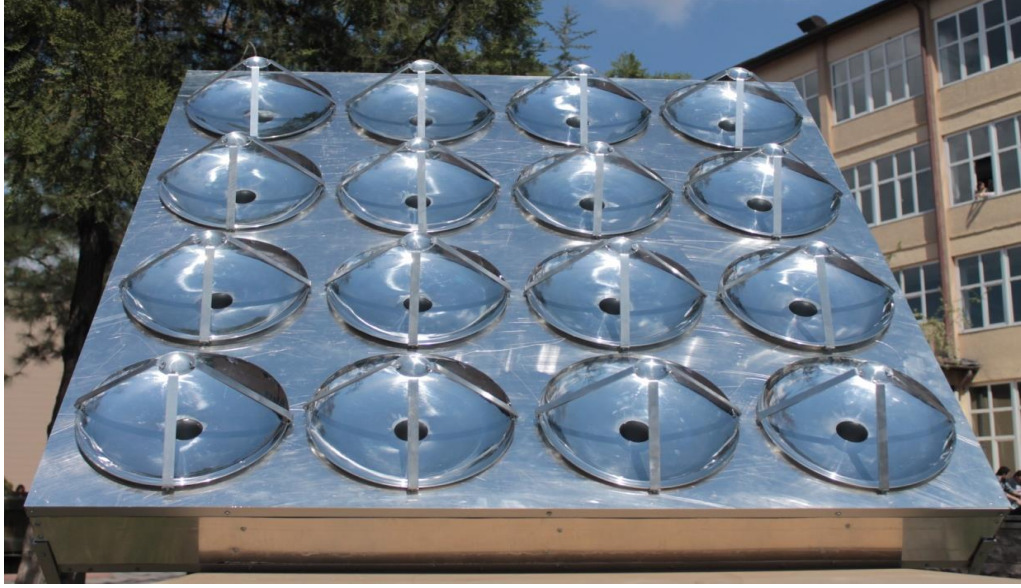
Resim 5.11. 16'lı parabolik yoğunlaştırıcı prototip sistemin kutulanmış görünüşü
