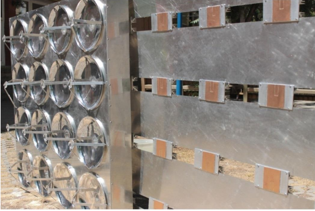
Resim 5.9. 16'lı parabolik yoğunlaştırıcı prototip sistemin ön yüzey görünüşü
