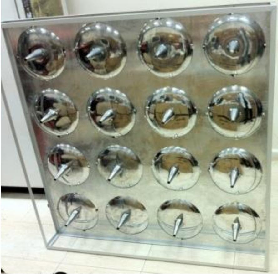
Resim 5.8. 16'lı parabolik yoğunlaştırıcı optik modülün arka yüzeyi
