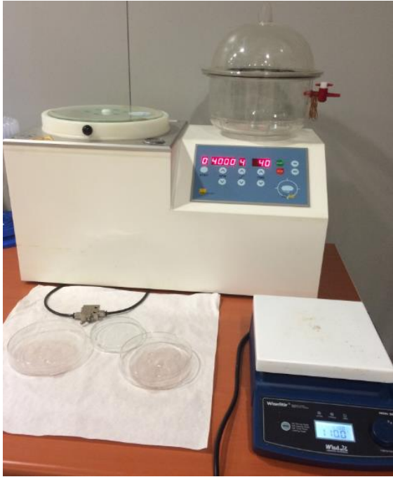
Resim 3.2. Dönel kaplama cihazı (Gazi Fotonik)
