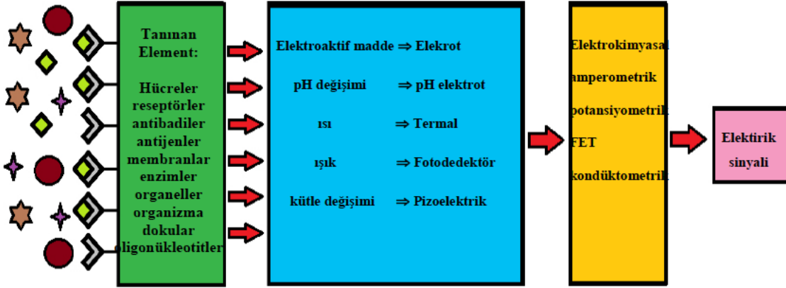
Şekil 2.8. Biyosensörün çalışma prensibi
