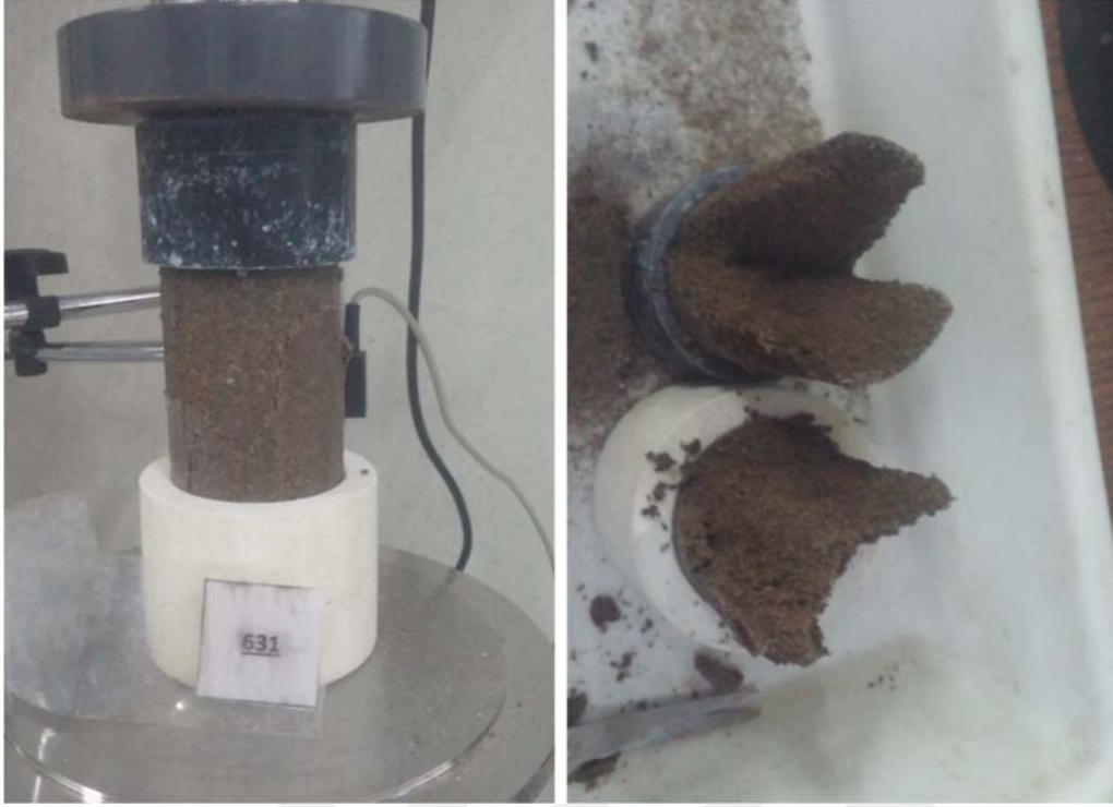
Resim 3.18. Enjeksiyon numunelerinin serbest basınç testine ait deney fotoğrafı
