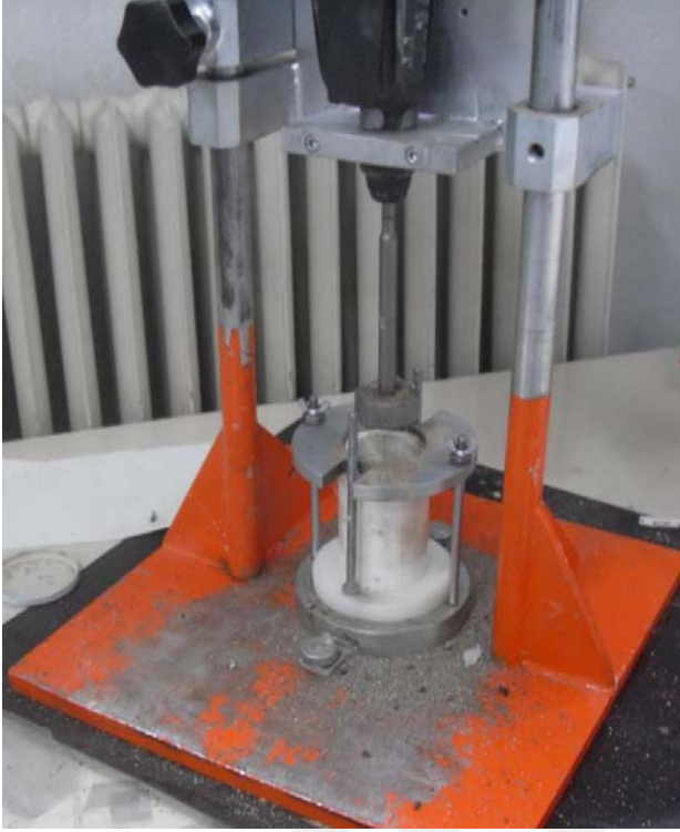
Resim 3.9. Moldun titreşimli tokmağa yerleştirilmesi
