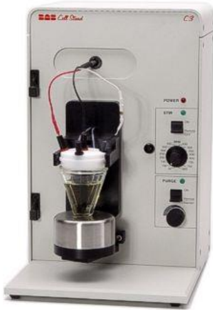
Resim 5.1. Üç elektrotlu elektrokimyasal sistem
