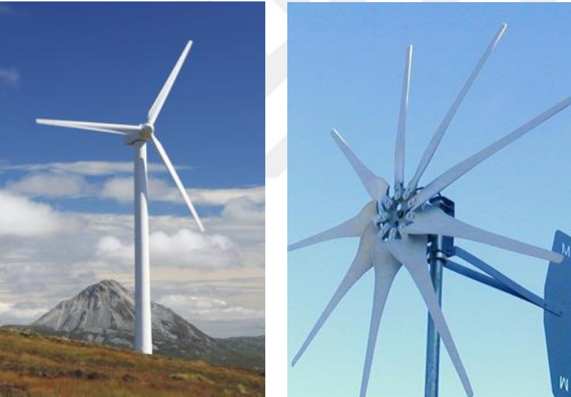
Şekil 3.6. Üç kanatlı ve çok kanatlı rüzgâr türbini
