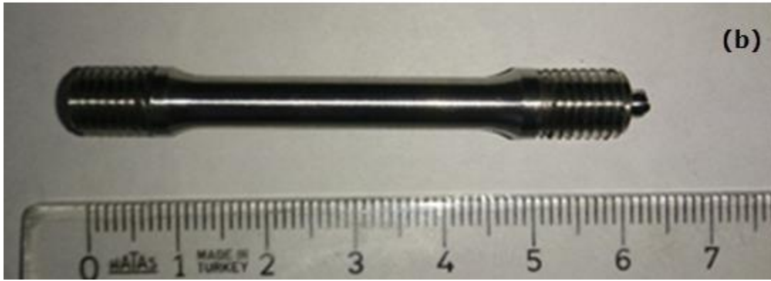
Şekil 3.3. ASTM E8 standart ölçüleri a) ASTM E8 standardı çekme çubuğu ölçüleri, b) ASTM E8 standardına göre işlenmiş çekme numunesi
