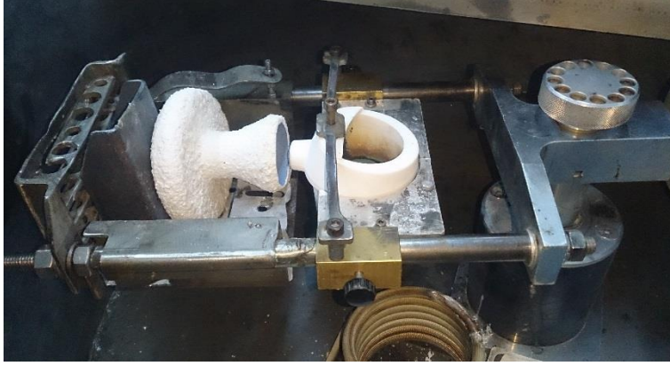
Resim 3.4. Seramik kalıbın vakumlu indüksiyon ocağında konumu
