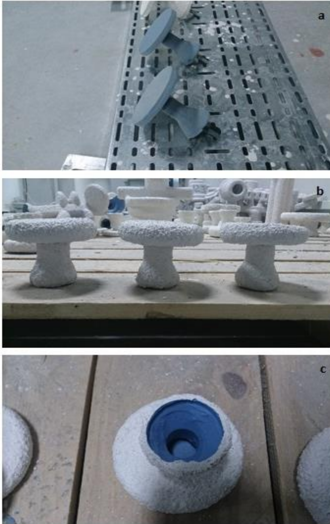
Resim 3.2. Seramik kaplama işlemleri a) Mum model salkımının seramik malzeme ile kaplanması (I. kaplama), b) mum model salkımının seramik malzeme ile kaplanması (son kaplama) c) mum boşaltma ve pişirme işlemi tamamlanmış seramik kalıplar
