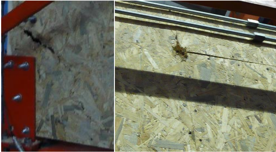
Şekil 7.28. Model-7'ye ait OSB üzerinde meydana gelen gerilmeler
