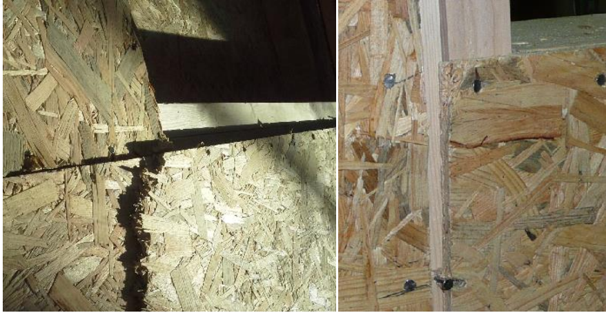
Şekil 7.20. Model-5'e ait OSB üzerinde meydana gelen gerilmeler
