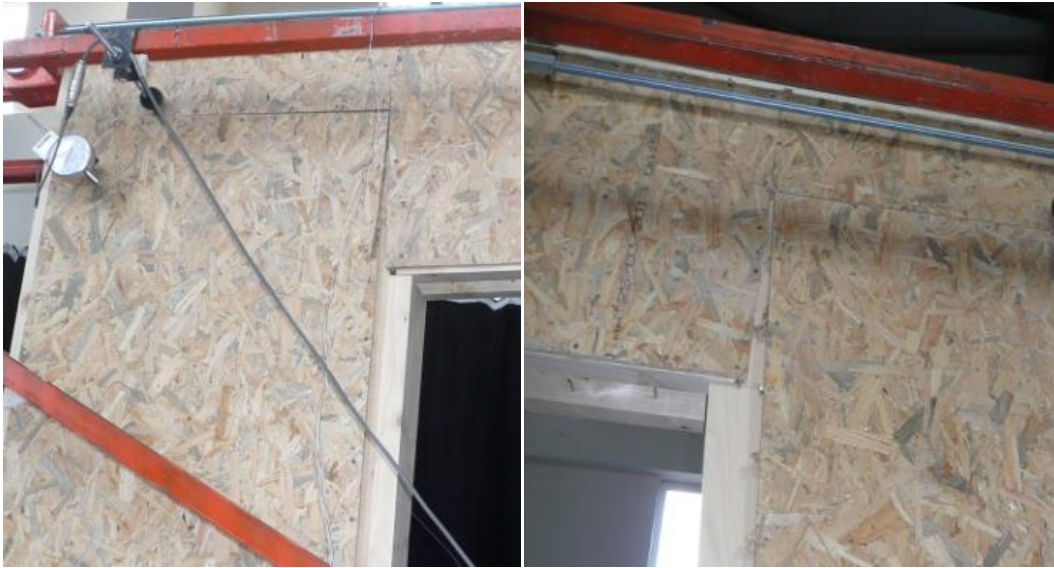
Şekil 4.65. Model-11'de meydana gelen hasar dağılımları
