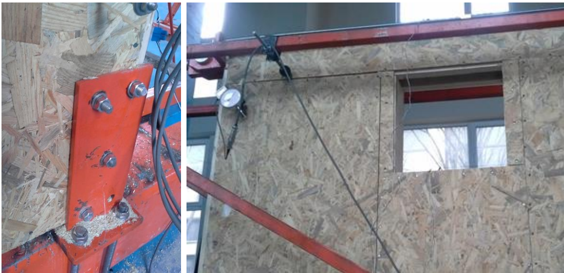
Şekil 4.55. Model-9'da meydana gelen hasar dağılımları
