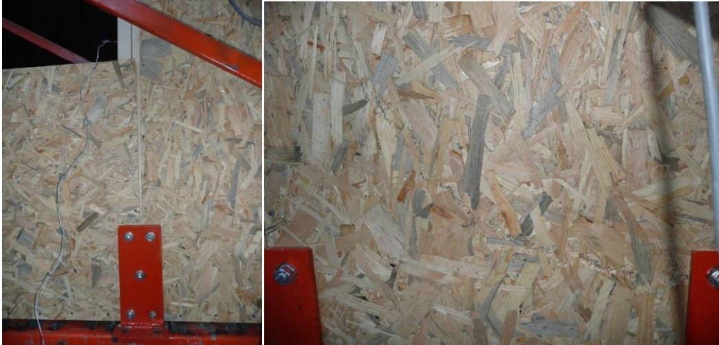
Şekil 4.60. Model-10'da meydana gelen hasar dağılımları
