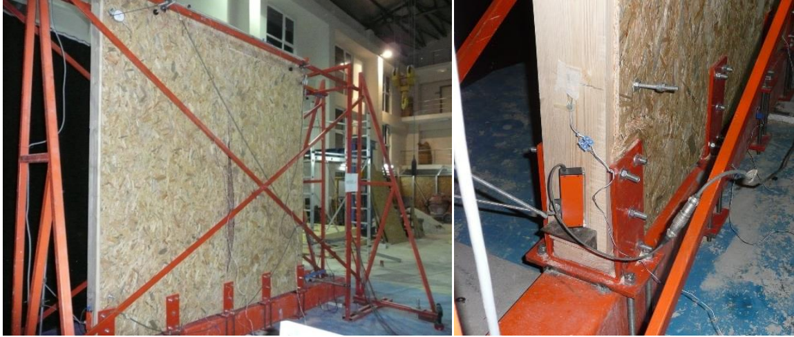
Şekil 4.40. Model-6'da meydana gelen hasar dağılımları
