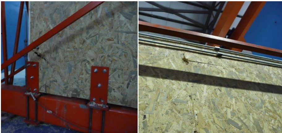
Şekil 4.45. Model-7'de meydana gelen hasar dağılımları
