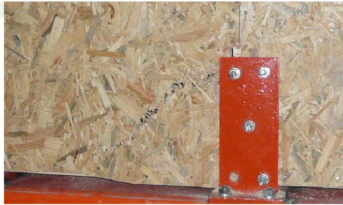
Şekil 7.12. Model-3'e ait OSB üzerinde meydana gelen gerilmeler
