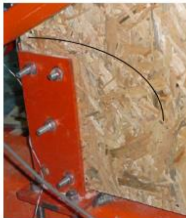
Şekil 7.24. Model-6'ya ait OSB üzerinde meydana gelen gerilmeler
