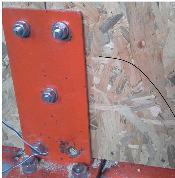
Şekil 7.35. Model-9'a ait OSB üzerinde meydana gelen gerilmeler
