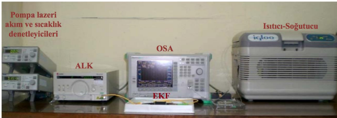
Resim 5.1. Sıcaklığa bağımlı kazanç spektrumu deneysel ölçüm düzeneği
