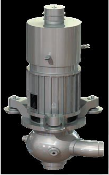
Şekil 3.5. Reaktör soğutucu pompası
