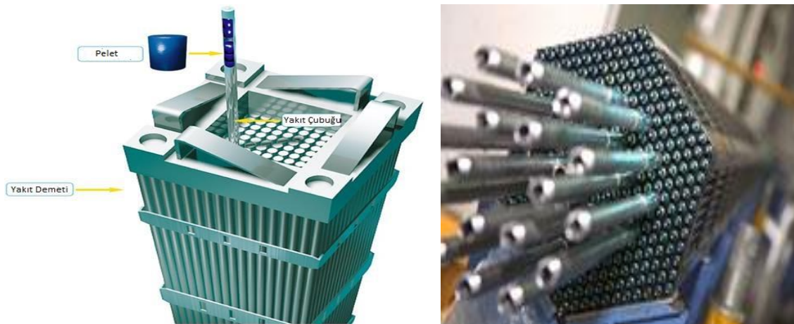
Şekil 2.3. Nükleer yakıt demeti
