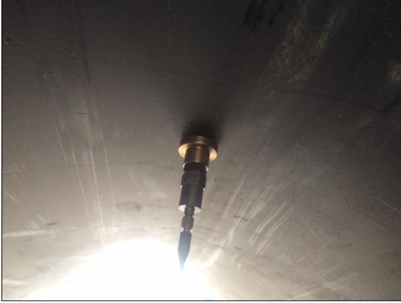
Resim 4.5. 600 mm dış çaplı boruya monte edilmiş piezoelektrik ivmeölçer
