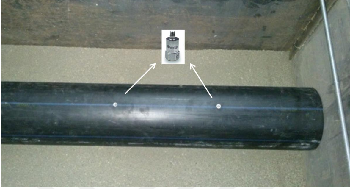
Resim 3.8. Boruya monte edilmiş iki adet piezoelektrik ivmeölçer
