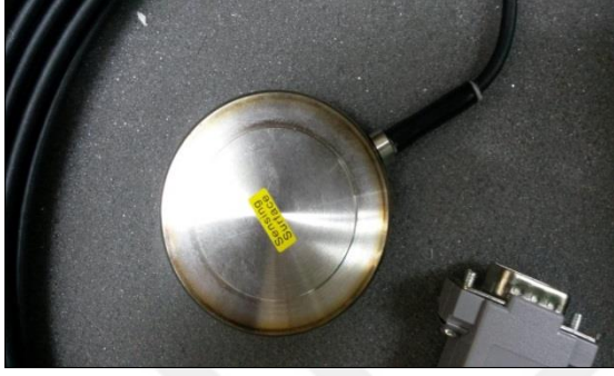
Resim 4.4. Arazi deneylerinde kullanılan basınçölçer
