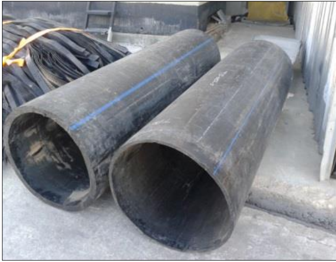
Resim 4.3. 600 mm dış çaplı HDPE boru
