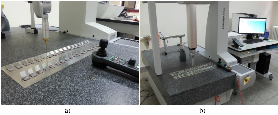
Şekil 4.11. Geri esnemenin CMM’de ölçümü a) Ölçüm işlemi b) Ölçüm ortamı
