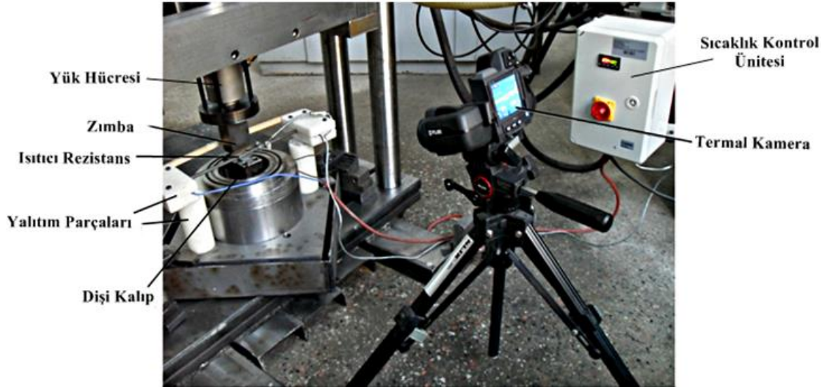
Şekil 4.2. Sıcaklık kontrol ve ısıtma ünitesi ile kalıp grubunun genel görüntüsü
