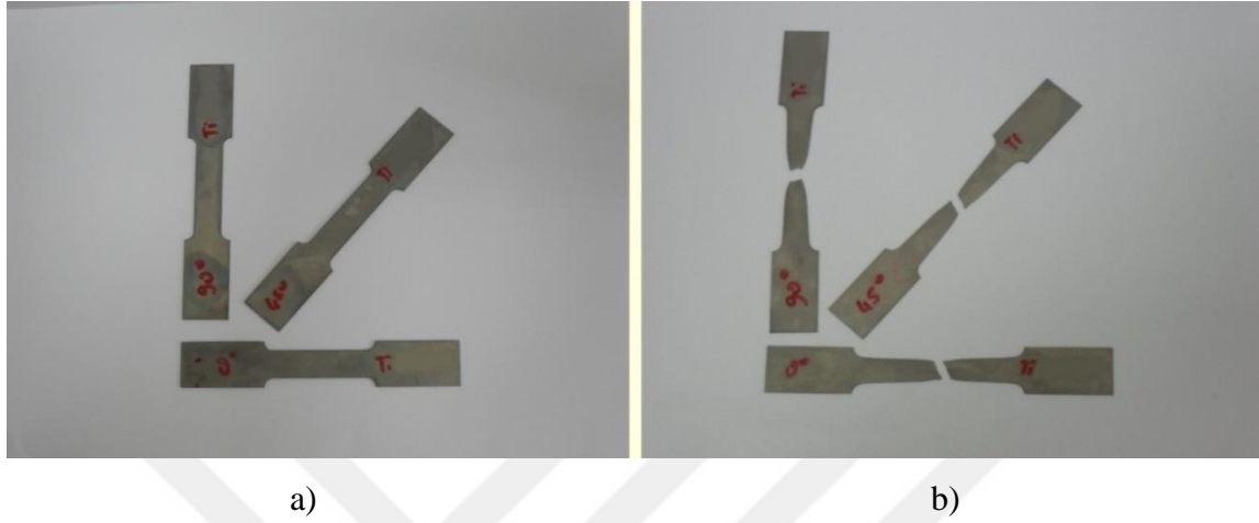
Şekil 4.9. Titanyum Grade 1 çekme testi numuneleri a) Test öncesi b) Test sonrası
