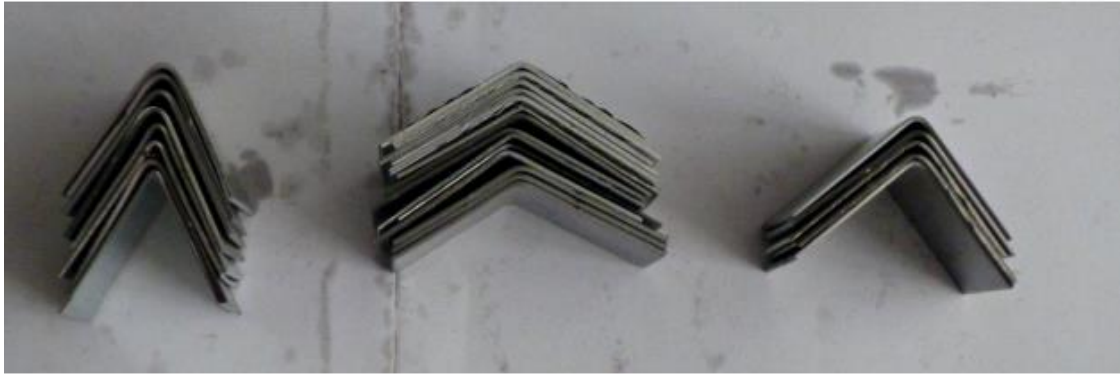
Şekil 2.1. V-bükme kalıplarıyla farklı açılarda şekillendirilmiş numuneler [2]
